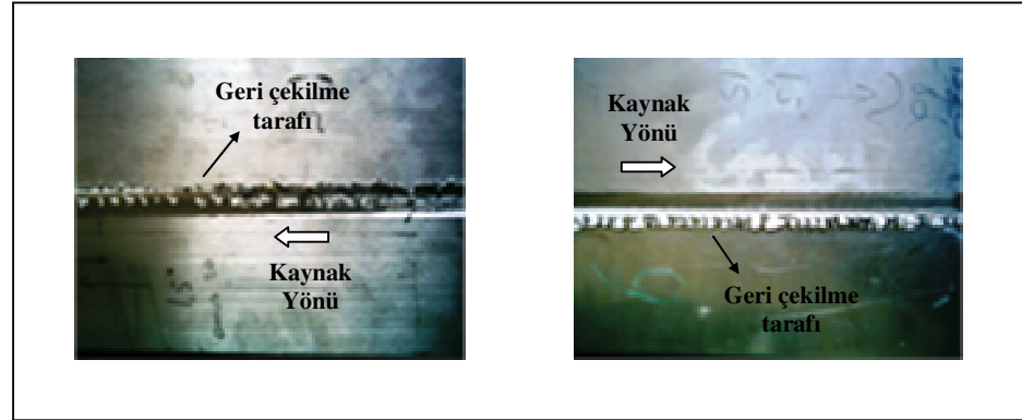
Şekil 3.59. Kaynak dikişinin geri çekilme tarafındaki malzeme yığılması.
