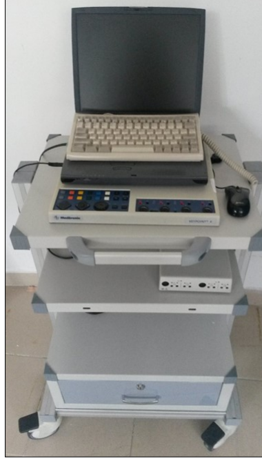
Şekil 19. Sinir iletim hız çalışmaları ile İğne EMG muayenelerinin gerçekleştirildiği cihaz.
