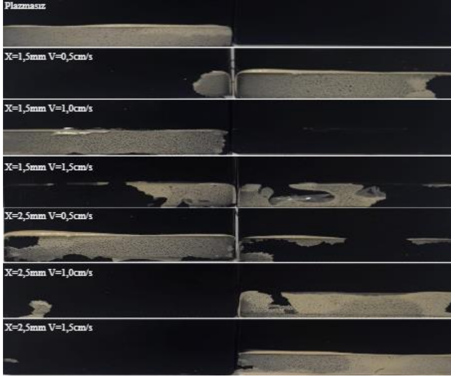
Şekil 4.6. Farklı hız ve mesafede plazma ile işlenmiş, Maracol yapıştırıcı ile bağlanmış POM numune çiftleri yüzeyleri yapışma bölgeleri
