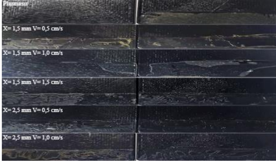
Şekil 4.7. Farklı hız ve mesafelerde plazma ile işlenmiş, G-Force Erde yapıştırıcı ile bağlanmış POM numune çiftleri yüzeyleri yapışma bölgeleri
