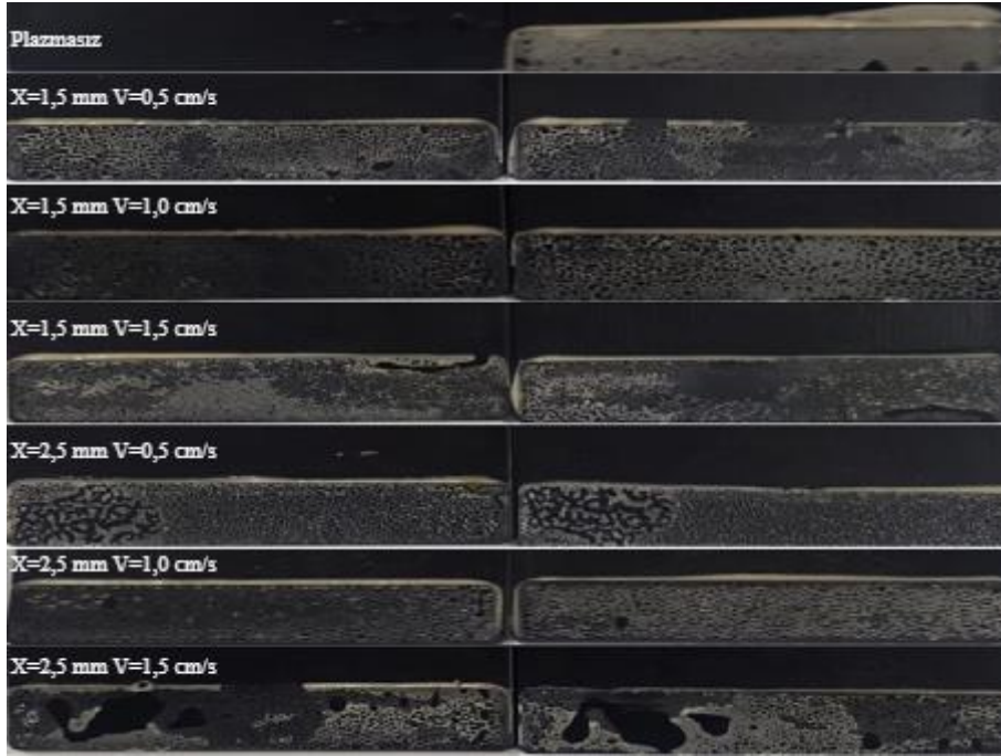
Şekil 4.4. Farklı hız ve mesafede plazma ile işlenmiş, Maracol yapıştırıcı ile bağlanmış PP numune çiftleri yüzeyleri yapışma bölgeleri
