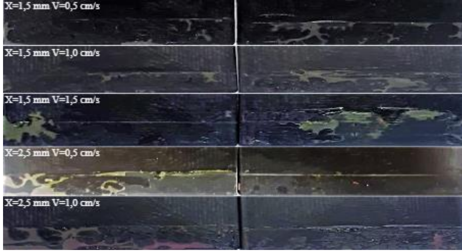
Şekil 4.5. Farklı hız ve mesafede plazma ile işlenmiş, G-Force Erde yapıştırıcı ile bağlanmış PP numune çiftleri yüzeyleri yapışma bölgeleri
