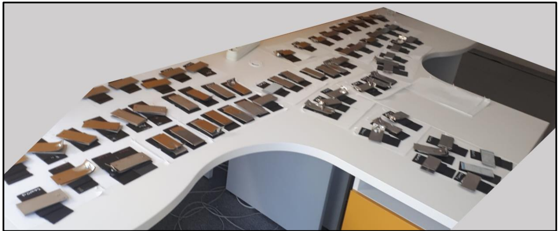
Şekil 4.3. Çekme testi için hazırlanmış çekme testi numuneleri
