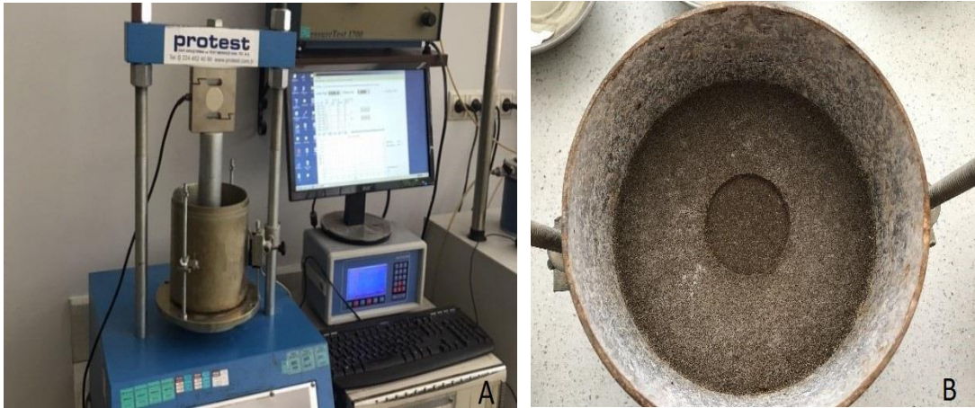
Şekil 3.10. CBR deney düzeneği ve K3Ç10UK karışımının 28 gün kür sonunda CBR testi sonrası görünüşü
