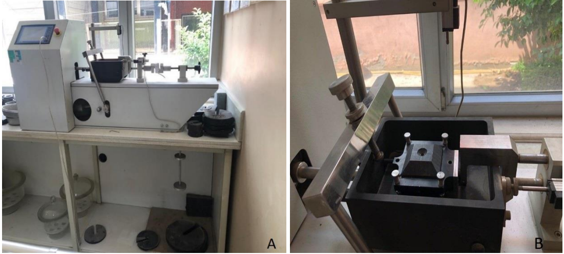
Şekil 3.8. Kesme kutusu deney cihazı ve kesme hücre sine yerleştirilen kesme kutusu
