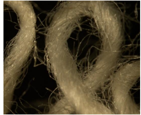
Şekil 4.1. %100 Pamuk İçin Ağartma İşlemi Görmüş Hav Buklesi (Sol) ve Enzimatik İşlem Görmüş Hav Buklesi (Sağ)
