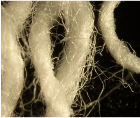
Şekil 4.1. %100 Pamuk İçin Ağartma İşlemi Görmüş Hav Buklesi (Sol) ve Enzimatik İşlem Görmüş Hav Buklesi (Sağ)
