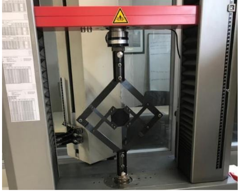
Şekil 3.6 Yapılan Çift Eksenli Çekme Deneyine Ait Bir Örnek
