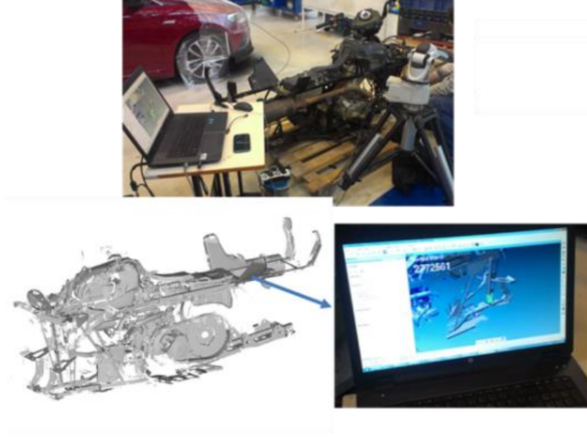
Şekil 3.14. Tersine mühendislik yöntemi ile 3D model oluşturulması
