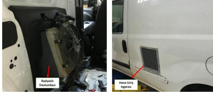
Şekil 3.18. Motor soğutma sistemi radyatör hava girişi uygulaması
