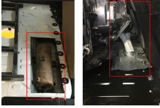
Şekil 3.22. Egzoz susturucusu ve egzoz borusunun fiziksel yerleşimi
