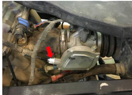
Şekil 3.23. İçten yanmalı motorun tel kontrollü gaz kelebeği
