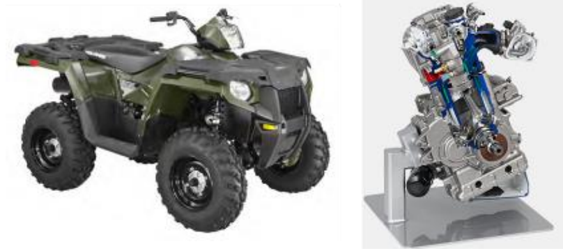
Şekil 3.2. Menzil artırıcı sistem için seçilen ATV motoru
