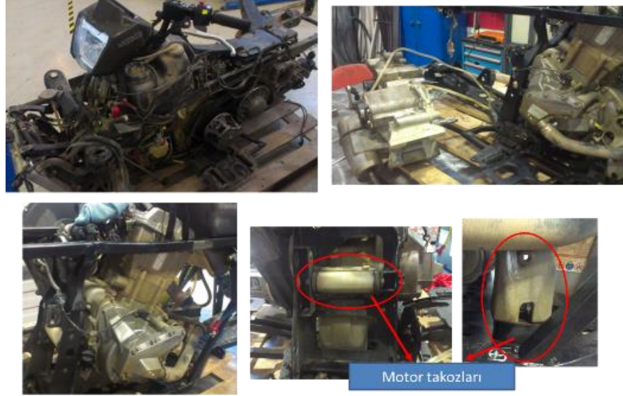
Şekil 3.4. Motorun ATV aracından sökülmesi
