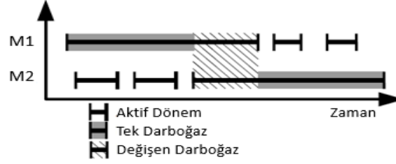
Şekil 5: Değişen Darboğaz Yöntemi (Roser ve diğ., 2003)
