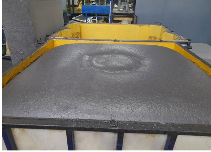
Şekil 3.4. Kasa içerisinde PU esaslı köpük üretimi
