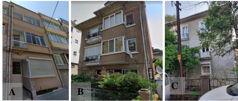
Şekil 4.30. 1950-1966 yapıları cephe tipolojisi örnekleri A) asimetrik, çıkmasız yapı B) asimetrik, tek çıkmalı C) simetrik, çıkmasız yapı (Fotoğraf: Betül Merve Pişkin, 2022)
