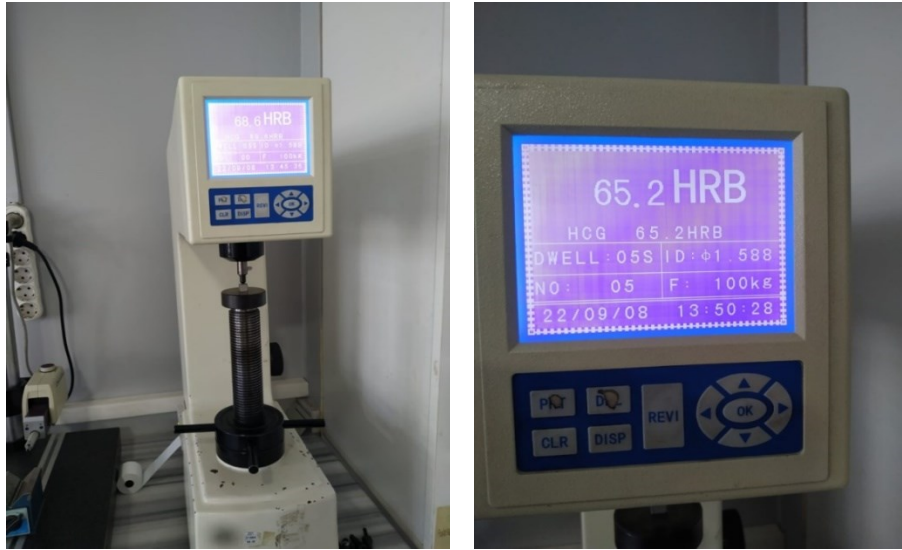
Şekil 3.11. Yamer RBVHT-1875 mikrosertlik ölçüm cihazının görselleri
