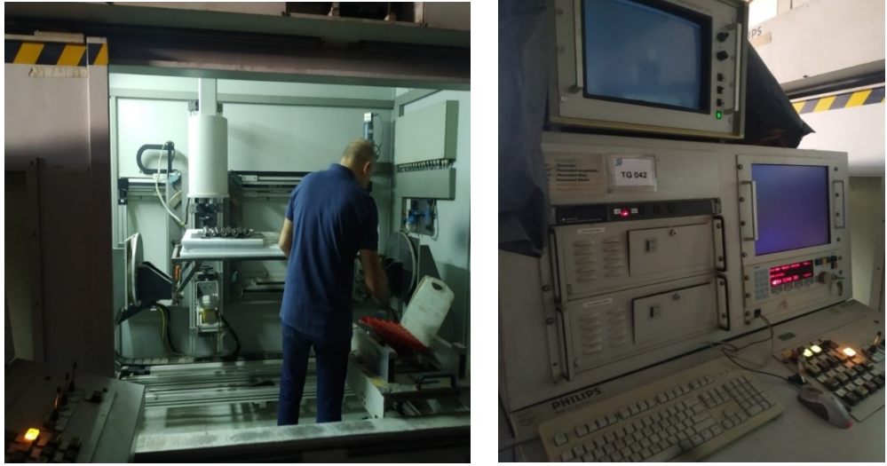
Şekil 3.12. Philips MU64 marka endüstriyel X-ray cihazına ait görseller
