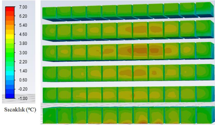
Şekil 3.89. HAD model FDM' siz ADSTD (kompresör kapalı) defrost 30. min M-paketler sıcaklık görünümü.
