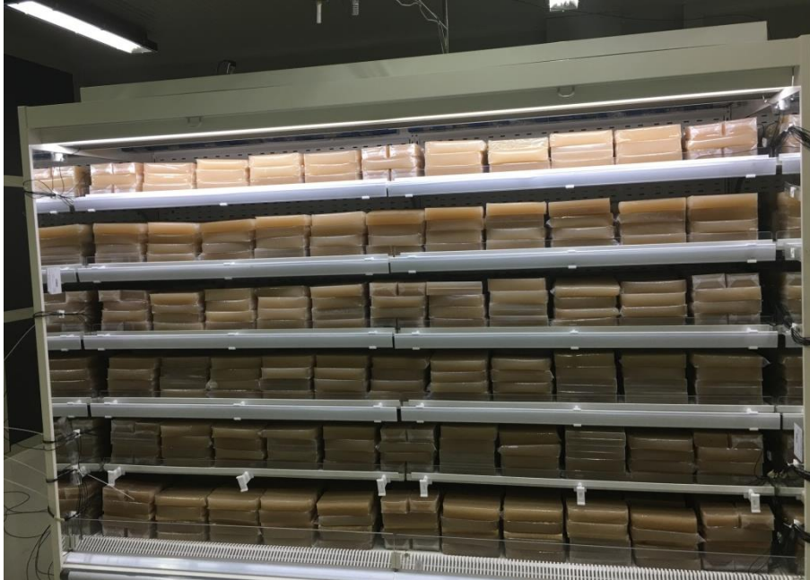
Şekil 3. Kabin içine yerleştirilmiş M paketler TS EN ISO 23953-2 Standartlarına göre test düzeneği (Figure 3. M package placed cabinet test setup according to TS EN ISO 23953-2 Standards)
