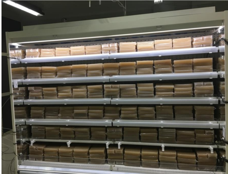
Şekil 3.5. A) TS EN ISO 23953-2 Standartlarına göre ölçüm noktalarının şematik gösterimi B) Kabin içi yerleşim planı ve yerleştirilmiş M paketler.
