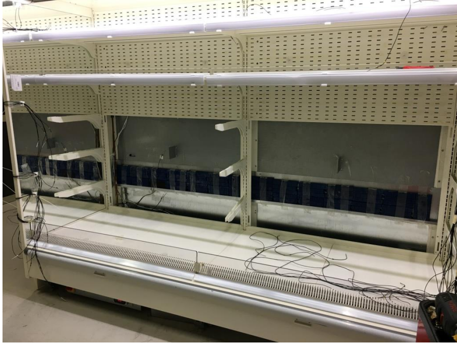
Şekil 4. ADSTD içerisine FDM kaplarının yerleşimi(Figure 4. Placements of PCM packets in the OVRDC)
