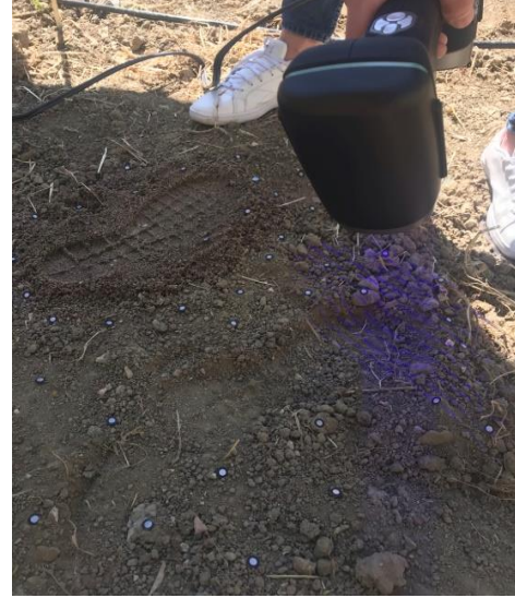
Şekil 4.4. Üç boyutlu izlerin kızılötesi mor ışık verilerek taranması
