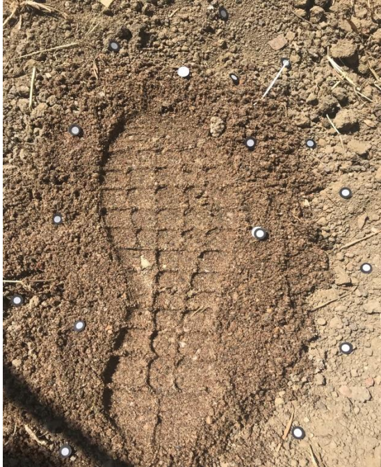
Şekil 4.5. Kumlu zemin üzerinde üç boyutlu ayakkabı izlerinin tarama sırasındaki görüntüsü
