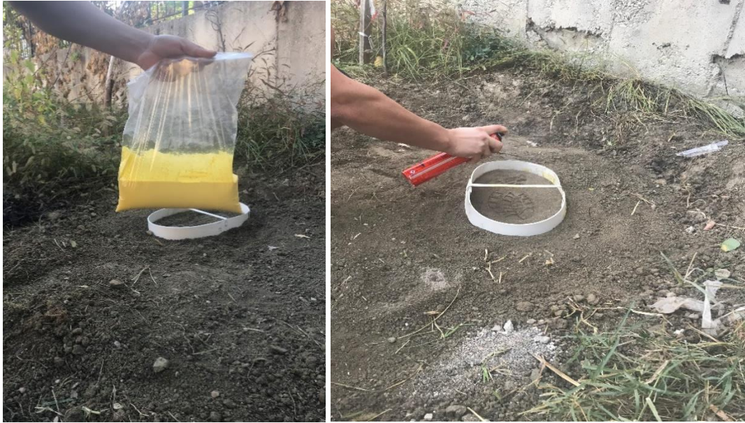
Şekil 4.16. Ayakkabı izinin kalıbının alınması için hazırlanan dişçi alçısı ve sertleştirici sprey kullanımı
