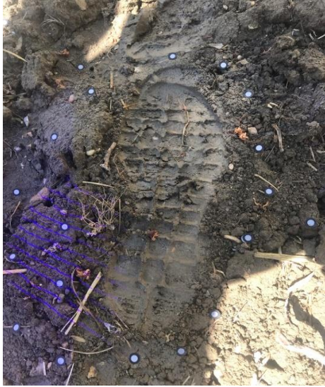
Şekil 4.4. Üç boyutlu izlerin kızılötesi mor ışık verilerek taranması
