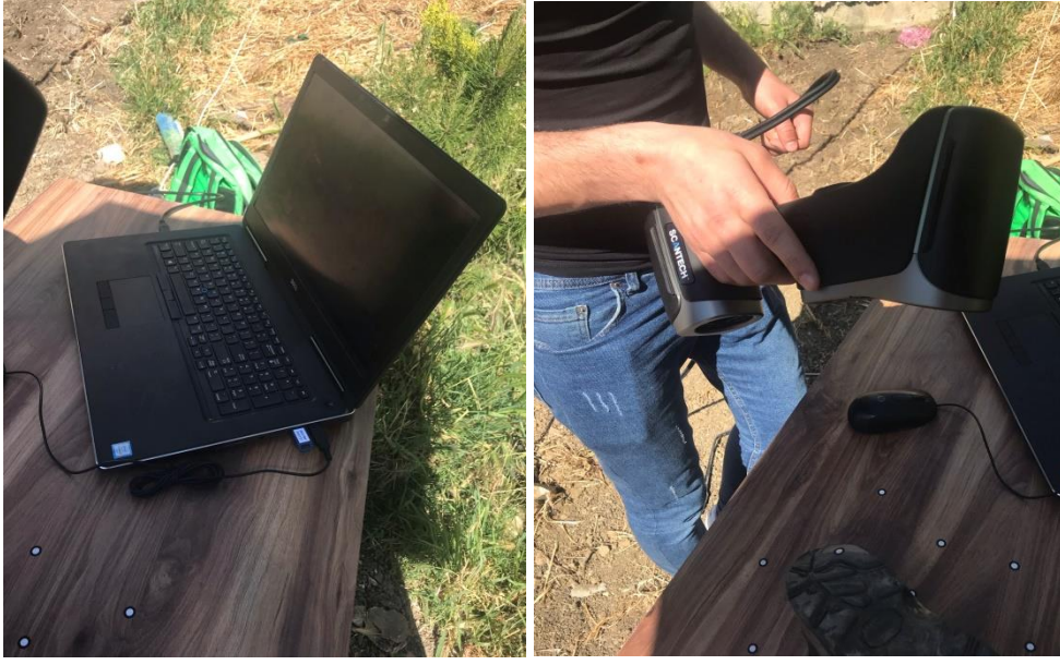
Şekil 4.2. Olay yerinde alınacak üç boyutlu izler için taşınabilir bilgisayar ve tarama cihazı
