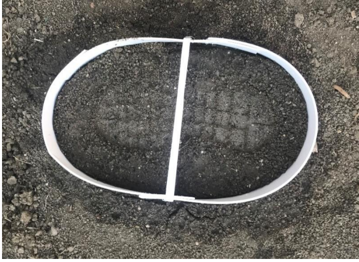
Şekil 4.15. Üç boyutlu ayakkabı izini almak için kullanılan alçı kalıbı
