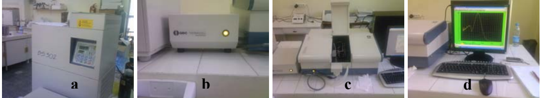
Şekil 2.5. UV spektrometresi a) soğutmalı su banyosu b)peltier termohücreci c) cintra 303 UV spektrometresi d) bilgisayar ekranı.
