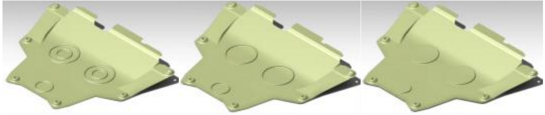
Şekil 4.3. Dairesel kabartma şekilleri sırasıyla, iç içe; tek; ve içi dolu
