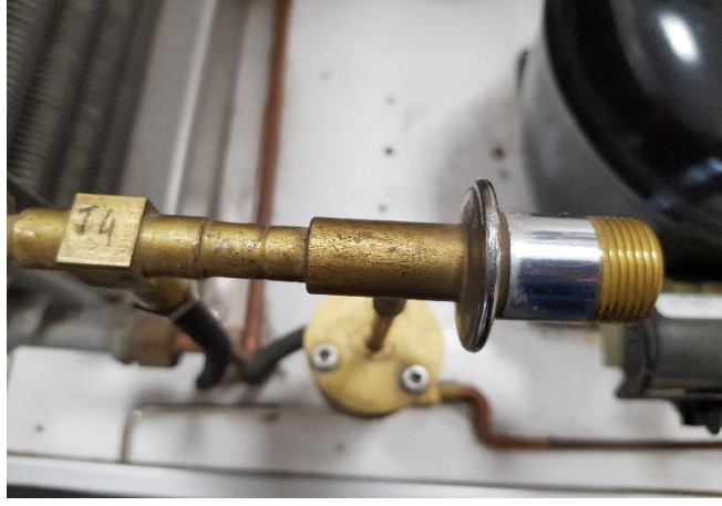
Şekil 3.3. Otomatik genleşme valfi
