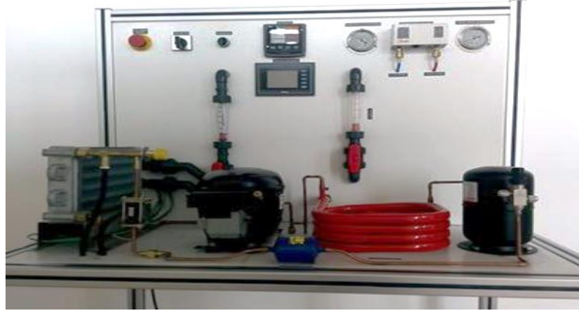
Şekil 3.1. R134a soğutucu akışkanlı sudan suya ısı pompası deney sistemi
