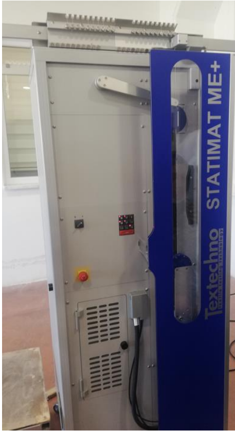
Şekil 3.8. Textechno STATIMAT ME+ iplik mukavemeti test cihazı
