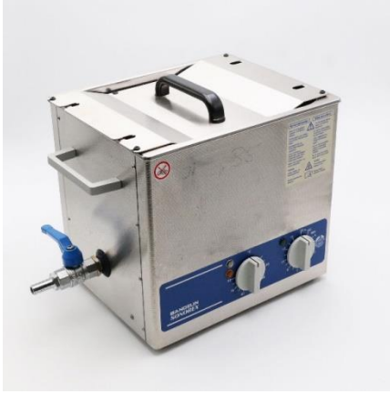
Şekil 1. Ultrasonik su banyosu (Bandelin Sonorex RK 510 H, Almanya)
