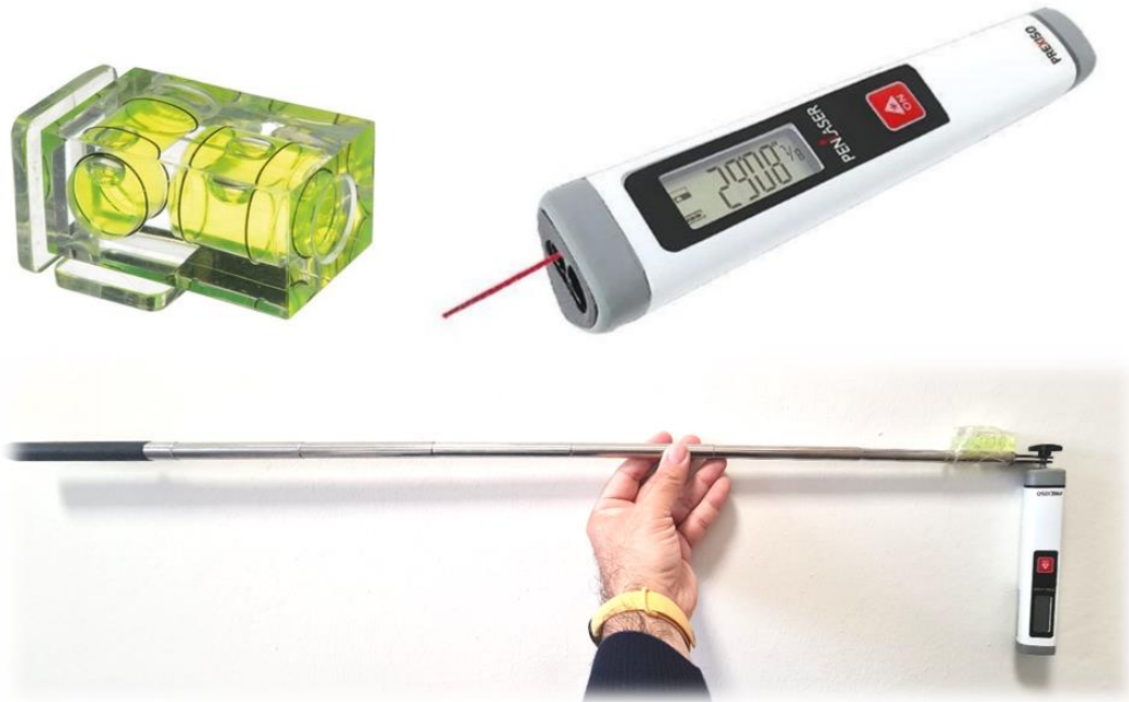
Şekil 3.2. Teleskobik çubuk ve su terazisi ile oluşturulan ölçü bastonu
