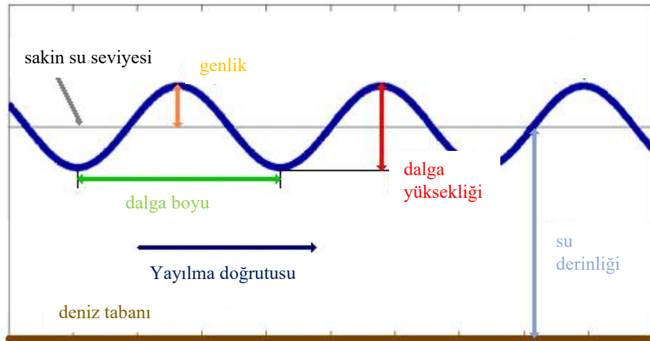
Şekil 2.4. Sinüs fonksiyonu biçimli dalga profili
