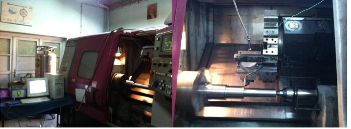
Şekil 3.4. JOHNFORD T35 CNC torna tezgahı (Boy,2004)
