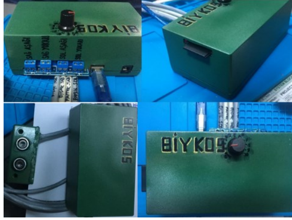
Şekil 4.10. Elektronik yükseklik kontrol sistemi kontrol ünitesi ve sensörler
