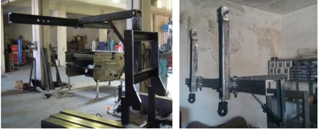
Şekil 3.7. Pamuk tepe kesme makinesinin imalat aşaması
