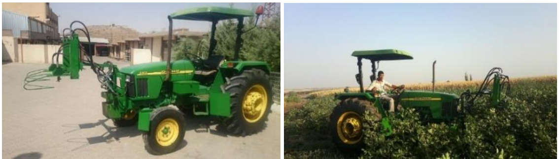
Şekil 4.7. Tepe kesme makinesinin traktör önündeki ve deneme arazisindeki pozisyonu
