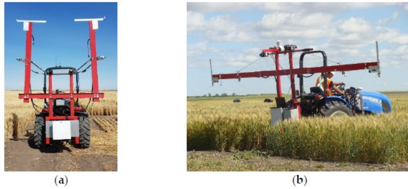
Şekil 2.21. Sensörler, kameralar, veri kaydedici, bilgisayar ve GPS alıcısı bulunan 6 fitlik bir Traktöre monte edilmiş bom: a) ulaşım (seyir hali) modu, b) genişletilmiş mod
