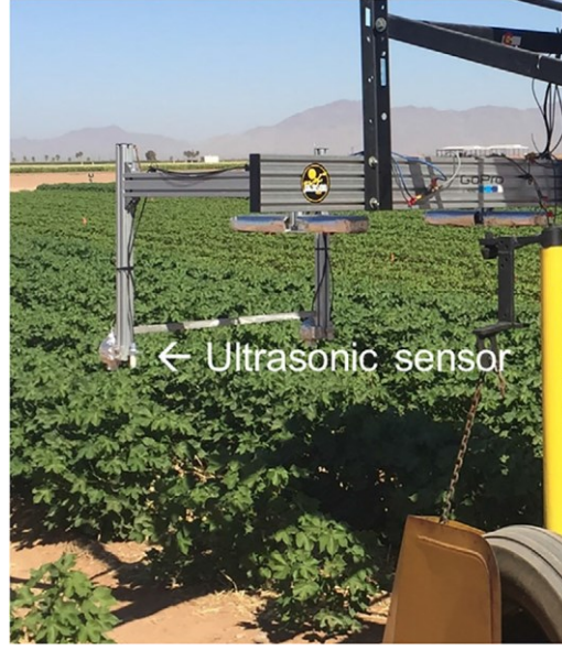
Şekil 2.16. Traktör önüne monte edilmiş ultrasonik sensör
