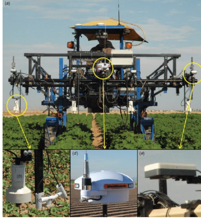
Şekil 2.8. Bitki fenotipleme makinesi a- sistemin önden görünümü, b- sonar yakınlık sensörü, c- kızılötesi radyometre sensörü, d- GPS-RTK alıcı-anteni, e- çok spektral mahsul gölgelik sensörü.
