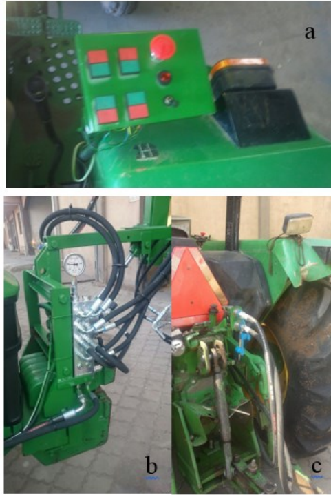
Şekil 4.9. Hidrolik sistem bağlantıları a) Hidrolik kumanda paneli, b) Selenoid valf ön bağlantıları, c) Arka bağlantılar
