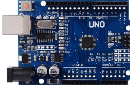
Şekil 3.13. Arduino Uno Mikrodenetleyici
