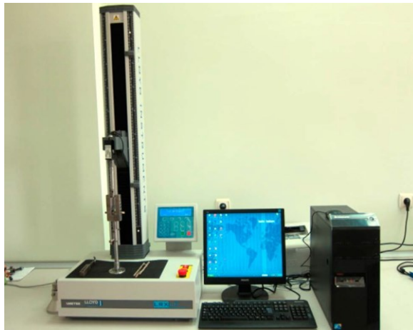
Şekil 3.1. Lloyd LRX Plus biyolojik materyal test cihazı
