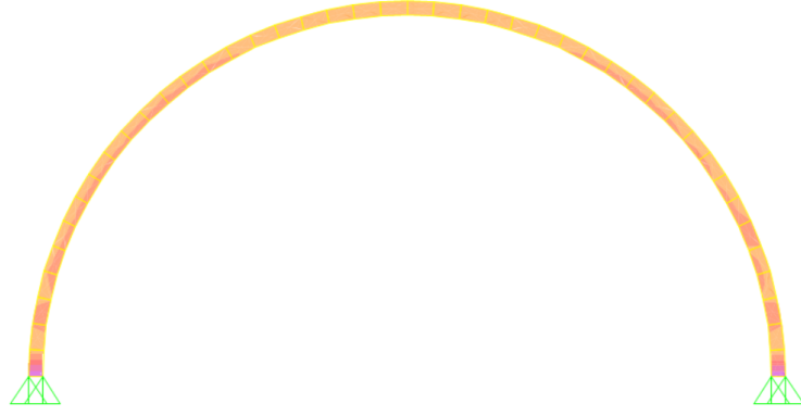
Şekil 3.57. Dairesel kemerdeki maksimum asal gerilmeler
