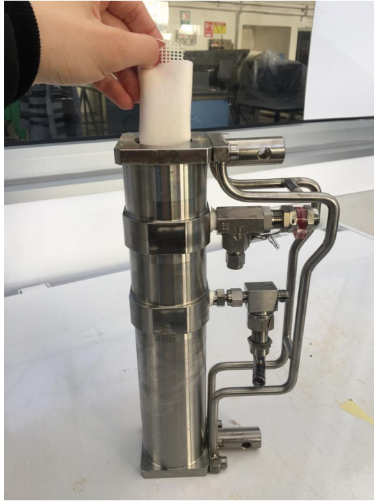
Şekil 3.2. Dye Coo susuz boyama tüpleri ve numunenin mesh'e sarılarak tüpe yerleştirilmesi
