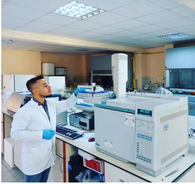
Şekil 18. Gaz kromatografi cihazıyla fekal uçucu yağ konsantrasyonlarının belirlenmesi.
