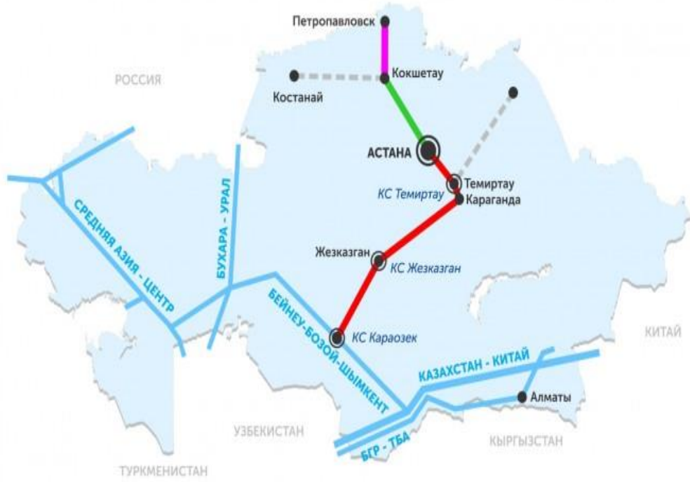
Şekil 6. Sariarka Gaz Boru Hattı Şeması
