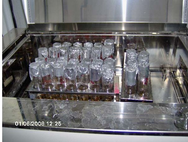
Şekil 5. Hücre Membran Zararlanması ve Yüksek Sıcaklık Stres Toleransının Tespiti Sırasında Su Banyosunda Yüksek Sıcaklık Uygulamasından Bir Görünüm
