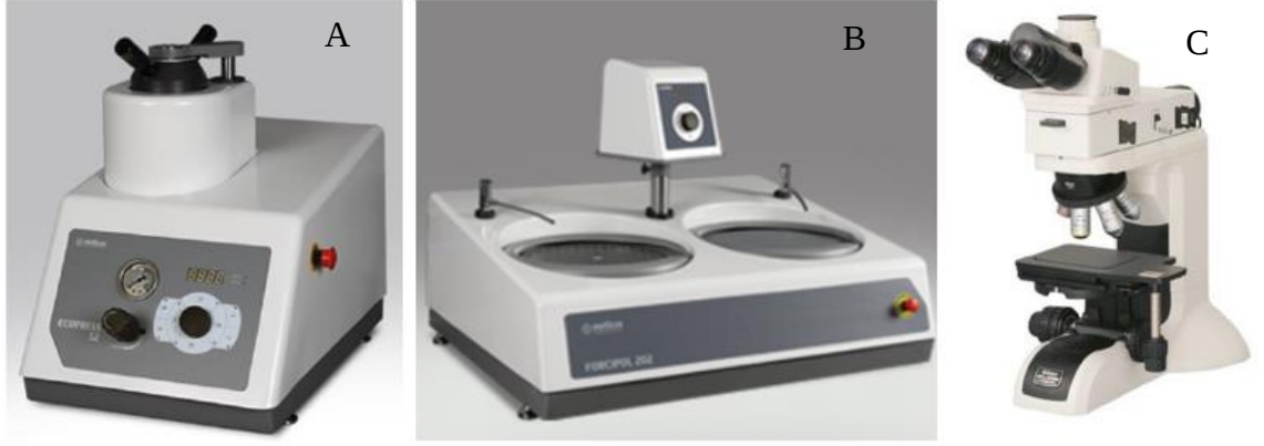
Şekil 3.6. Metalografik incelemede kullanılan cihazlar. A) Metkon Ecopress numune kalıplama cihazı B) Metkon Forcipol zımparalama- parlatma cihazı C) Nikon Eclipse LV150NL mikroskobu
