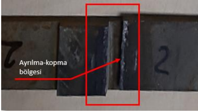
Şekil 4.11. Yorulma testi sonucunda kopan numune
