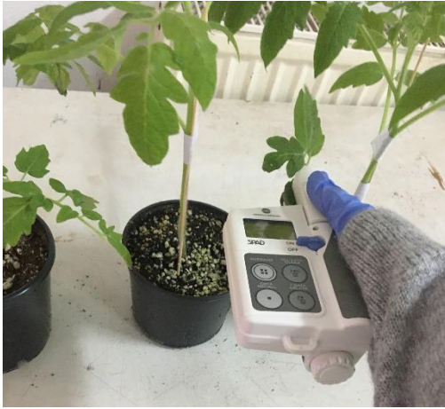
Şekil 3.13. Spad-502 ile gerçekleştirilen klorofil ölçümü
