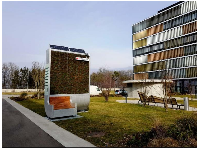
Şekil 2.16. “City Tree” hava temizleyici oturma elemanı (Anonim, 2018)
