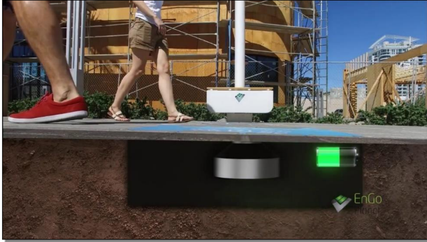
Şekil 2.12. Harekete dayalı elektrik üretme sistemi (Dent, 2016)
