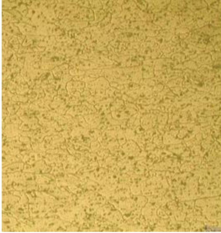
Şekil 3.1. Al 6061 T6 malzemesi iç yapı görseli
