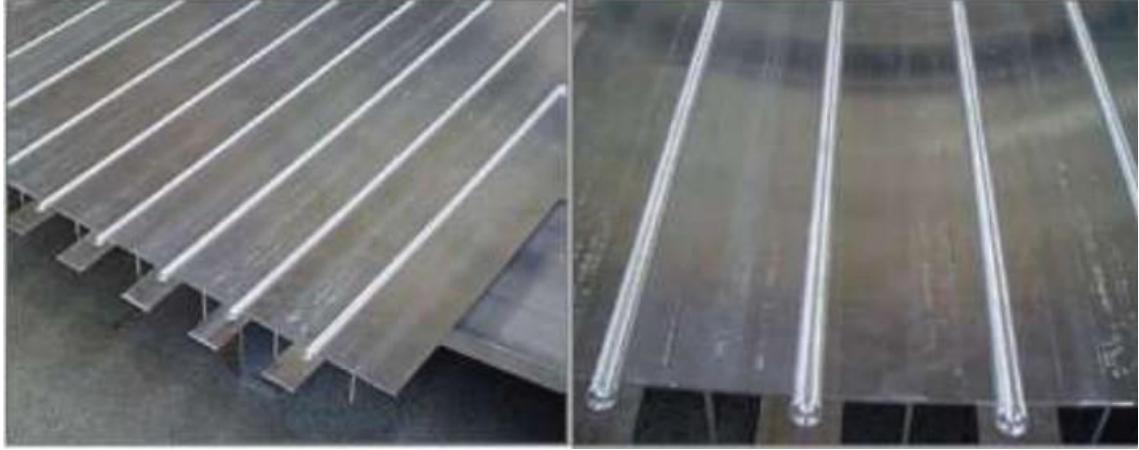
Şekil 2.7. SKK ile üretilmiş güverte ve yan panelleri (Besharati-Givi, M.K., Asadi, P.2014).
