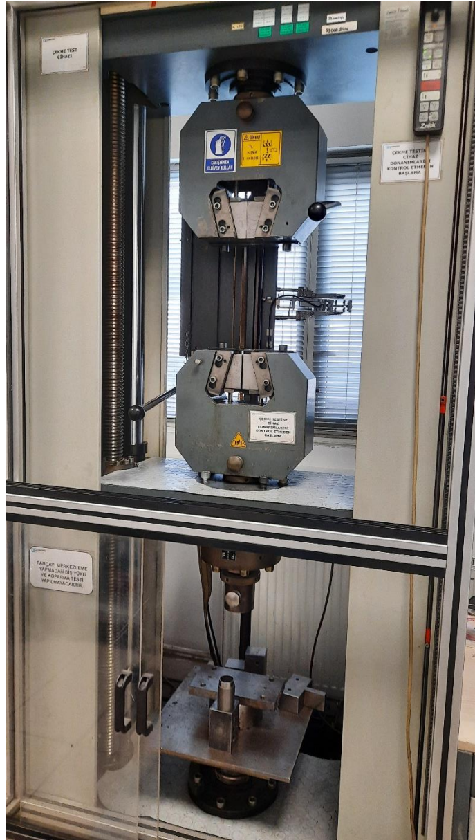
Şekil 3.5. Zwick 150 Sac çekme cihazı
