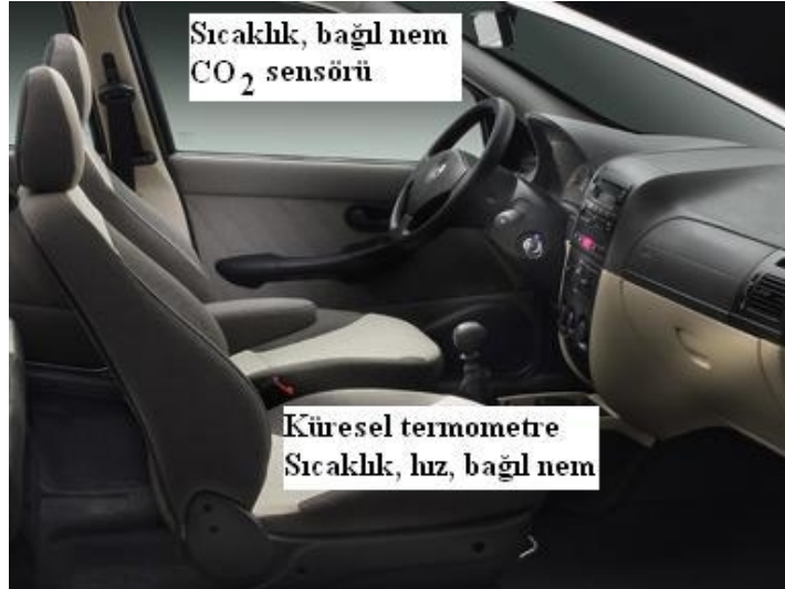
ekil 3.3 Kullanılan deney aletlerinin kabin içerisindeki yerleşimi.
