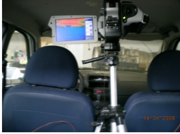
ekil 3.1 Aracın ön yüzeylerinin çekimi için kızılötesi kameranın konumu.
