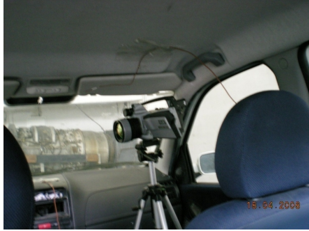
ekil 3.2 Sürücü yüz deri sıcaklığının ölçümü için kızılötesi kameranın konumu.
