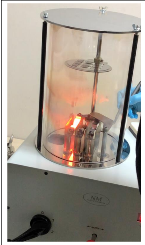
Şekil 3.8. Gümüş Buharlaştırma İşlemi
