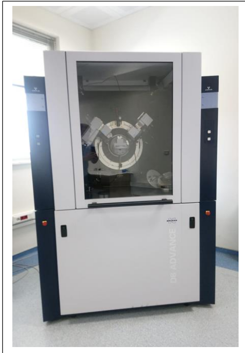
Şekil 3.21. X-ışını Toz Difraktometresi cihazı (dıştan görünümü)
