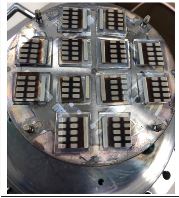
Şekil 3.17. Gümüş kontak atılan Perovskit güneş hücreleri
