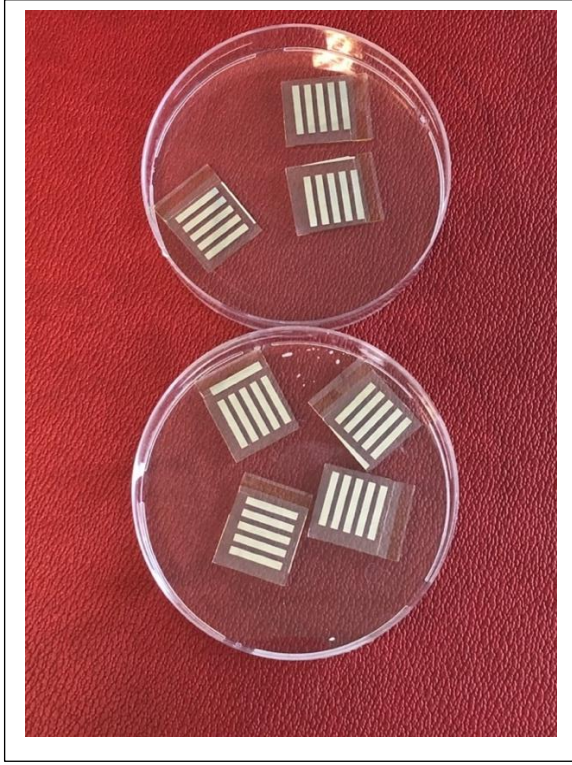
Şekil 3.9. Gümüş kontak atılan TiO 2 malzemeler
