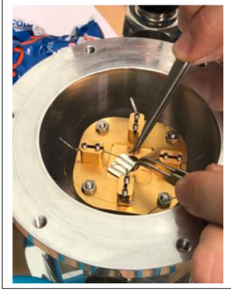
Şekil 3.30. Kriostata malzeme yerleştirilmesi
