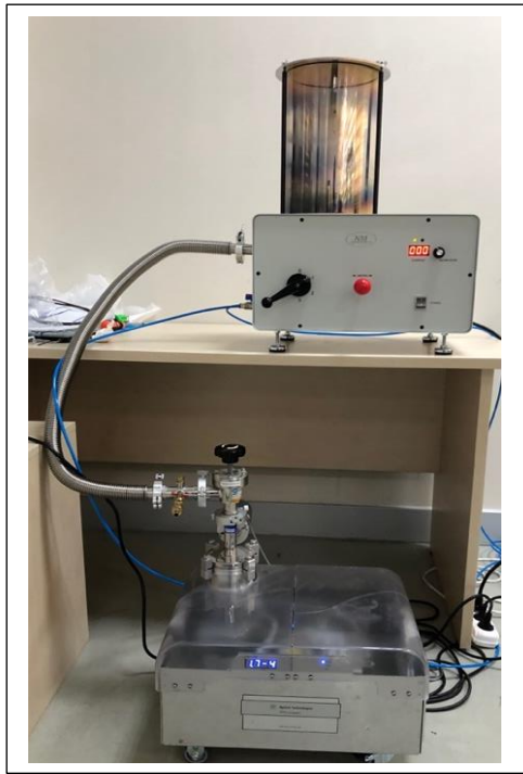
Şekil 3.6. Metal buharlaştırma cihazı
