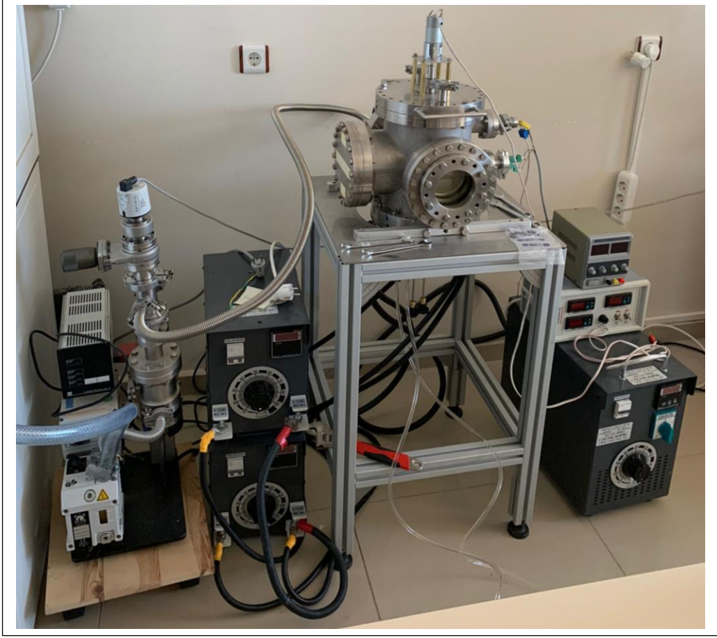
Şekil 3.10. Termal buharlaştırma sistemi
