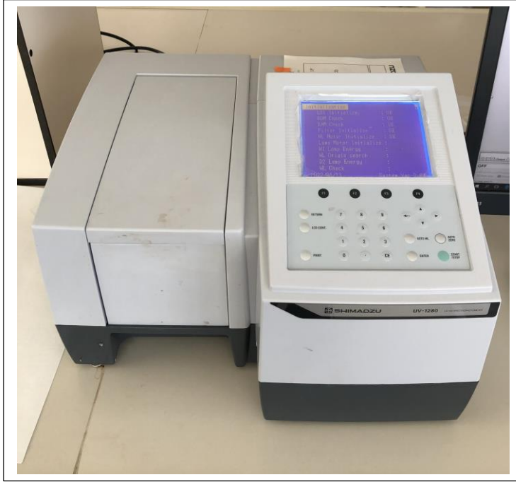
Şekil 3.25. Morötesi ve Görünür Bölge (UV-Vis) Soğurma Spektroskopisi cihazı
