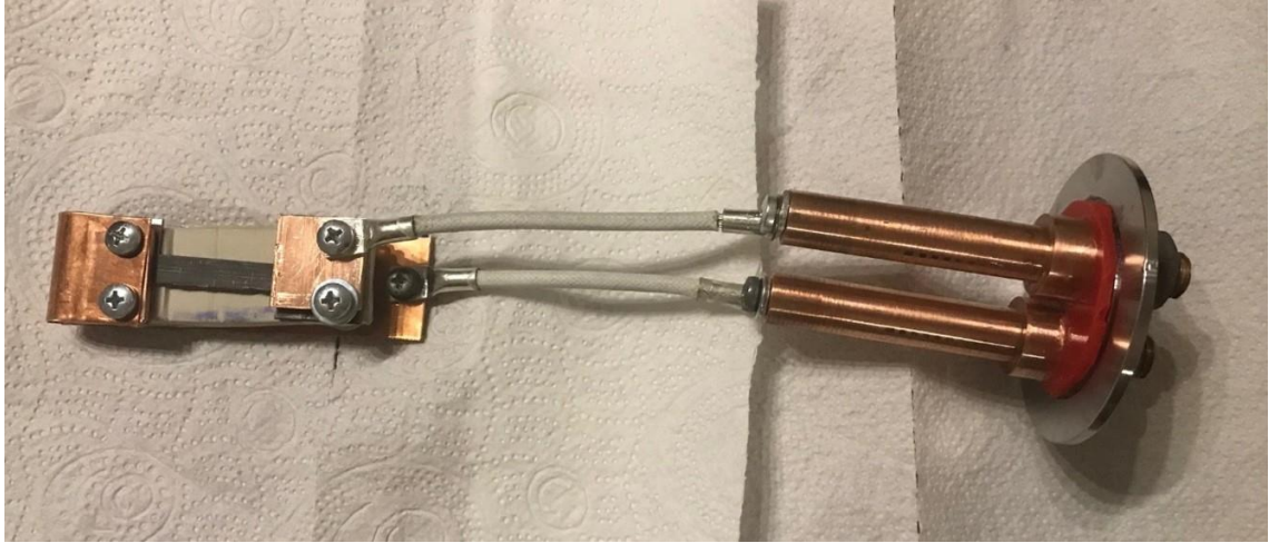
Şekil 3.10.4 KF50 kör flanş üzerine silikon conta ile monte edilmiş bakır elektrotlar ve sıcak yüzey montajı
