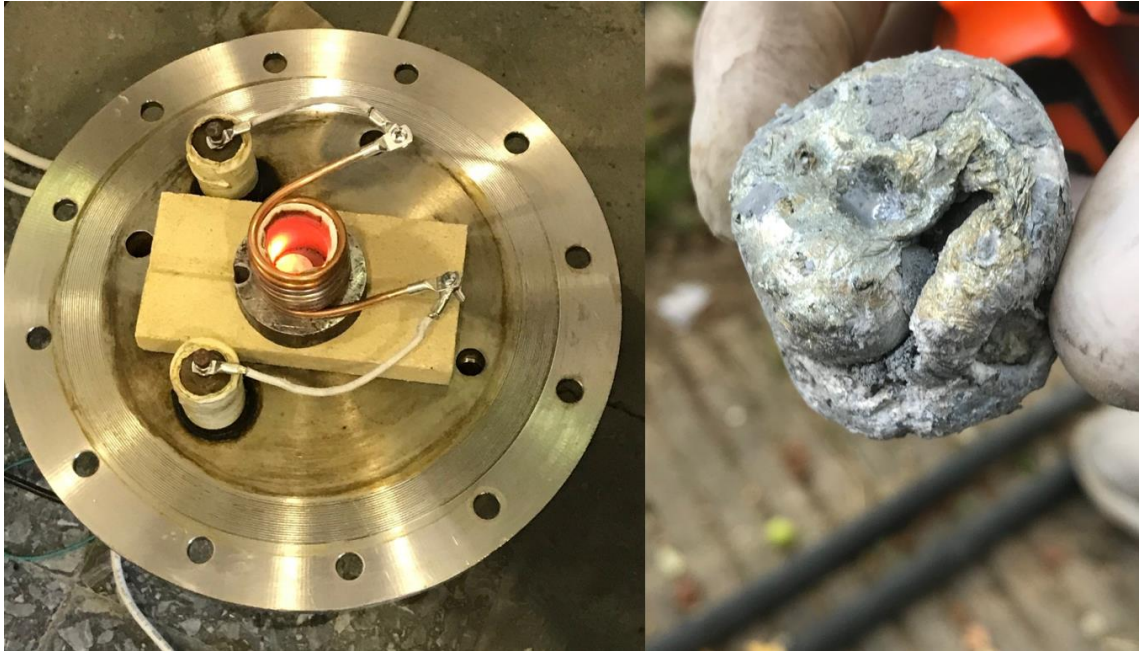
Şekil 3.11.3 İndüksiyon kalıbı içerisine yerleştirilen sıkıştırılmış alüminyum bloğun vakum altında yer tutucular üzerine eritilmesi
