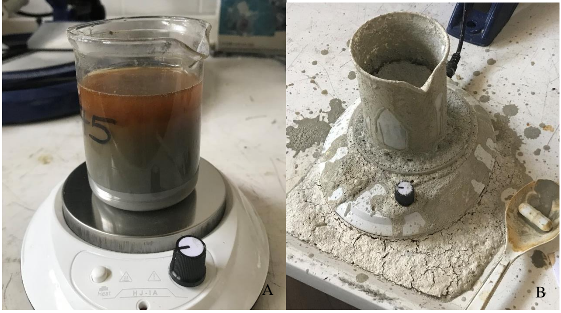
Şekil 3.9.6 A) Demir III Nitrat süspansiyonu B) Demir III Nitrat- Aluminyum tozu karışımının gösterdiği reaksiyon.
