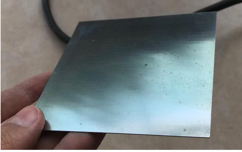
Şekil 3.4.4 Yüksek ergime derecesine sahip molibden plaka
