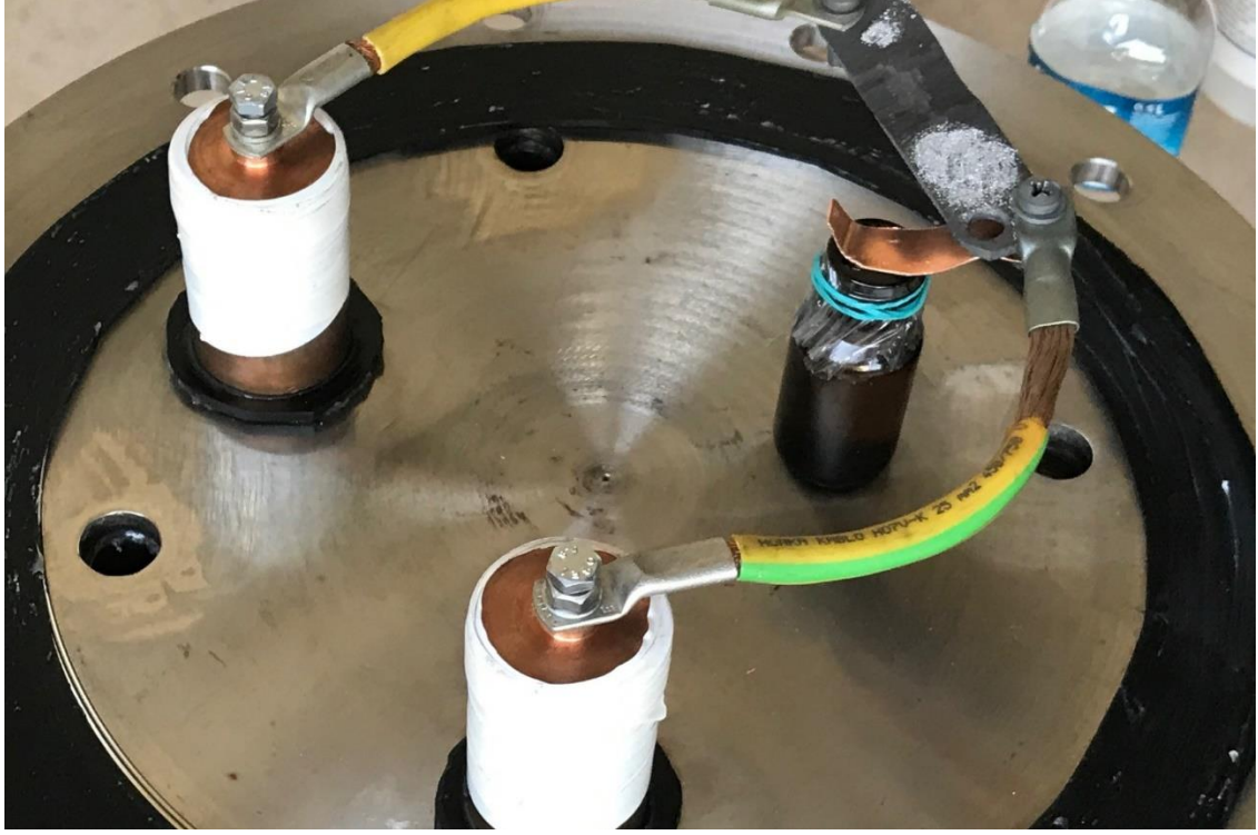
Şekil 3.4.10 Grafit plakanın direkt olarak Bakır kutuplardan gelen kablolara bağlantısı
