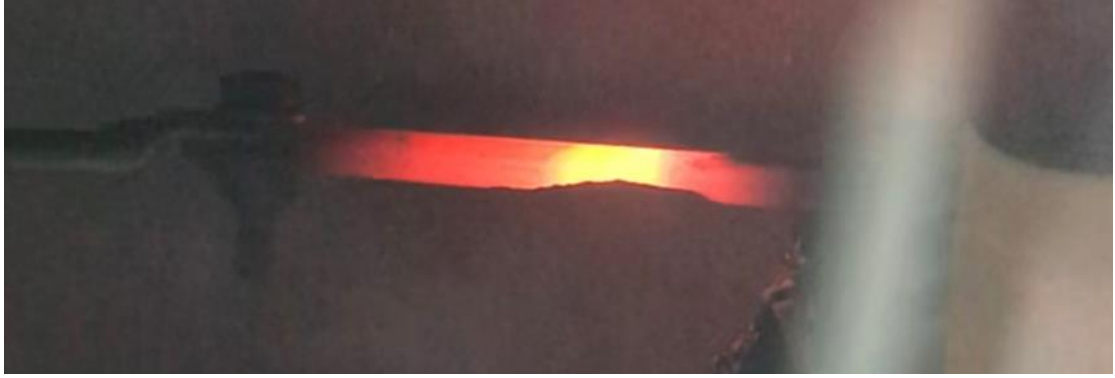
řekil 3.4.11 Vakum altında ısıtılan grafit plaka
