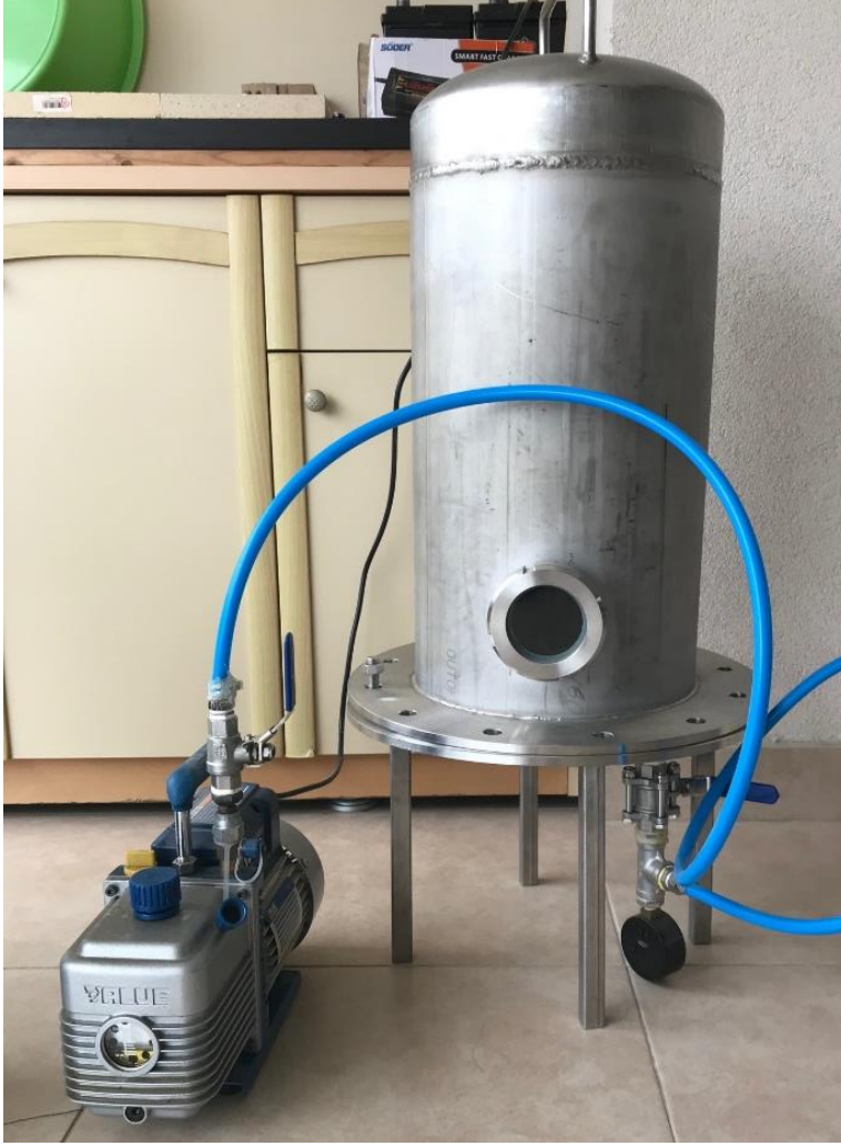
Şekil 3.3.3 CVD metodu ile karbon nanotüp üretim tankı ilk montaj
