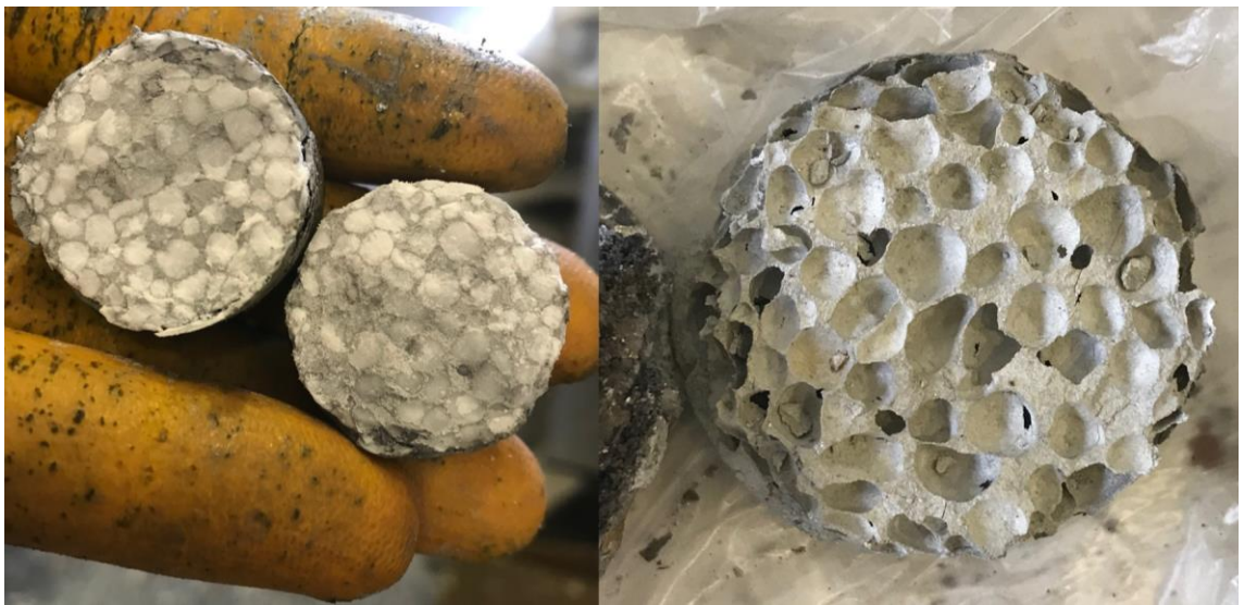
Şekil 3.11.5 Üre taneleri ile homojen dağılmış hücre yapısı
