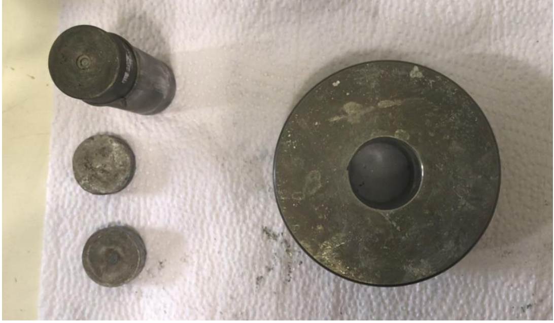
Şekil 3.12.1 Köpük malzeme üretiminde kullanılan Kalıp, maça ve pullar
