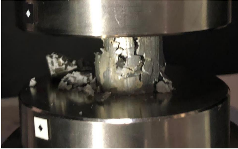
Şekil 3.13.4 300C de sinterlenmiş bir numunenin basma testinde gevrek kırılışı
