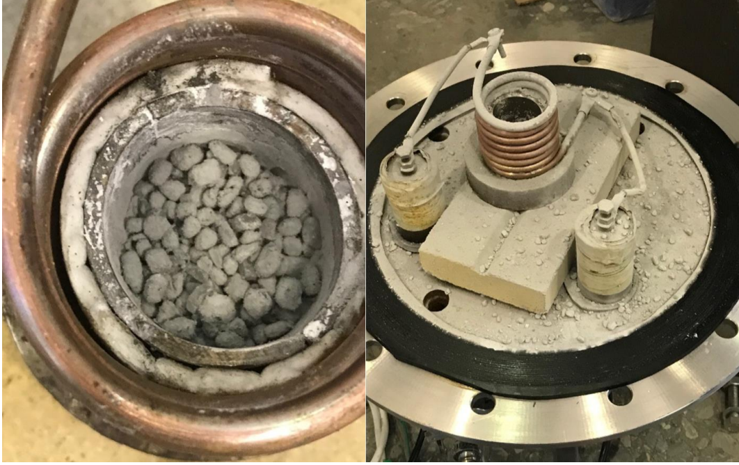
Şekil 3.11.2 İndüksiyon bobini ile açılabilir çelik kalıp içerisine preslenmeden konan Alüminyum-tuz-TiH 2 matris. İşlem başladıktan kısa bir süre sonra tüm karışım tankın içine dağılmıştır.
