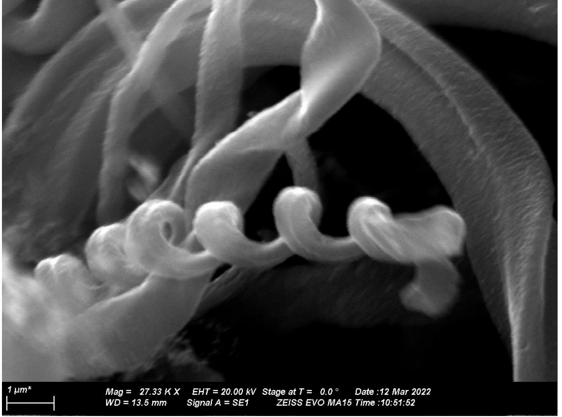
Şekil 2.3.2.2 SEM cihazı ile 27000 kere büyütülmüş bir karbon nanolif.
