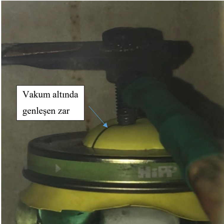
Şekil 3.8.1 Vakum seviyesinin artışıyla etanol dolu kabın içindeki kauçuk zarın patlatılması yöntemi
