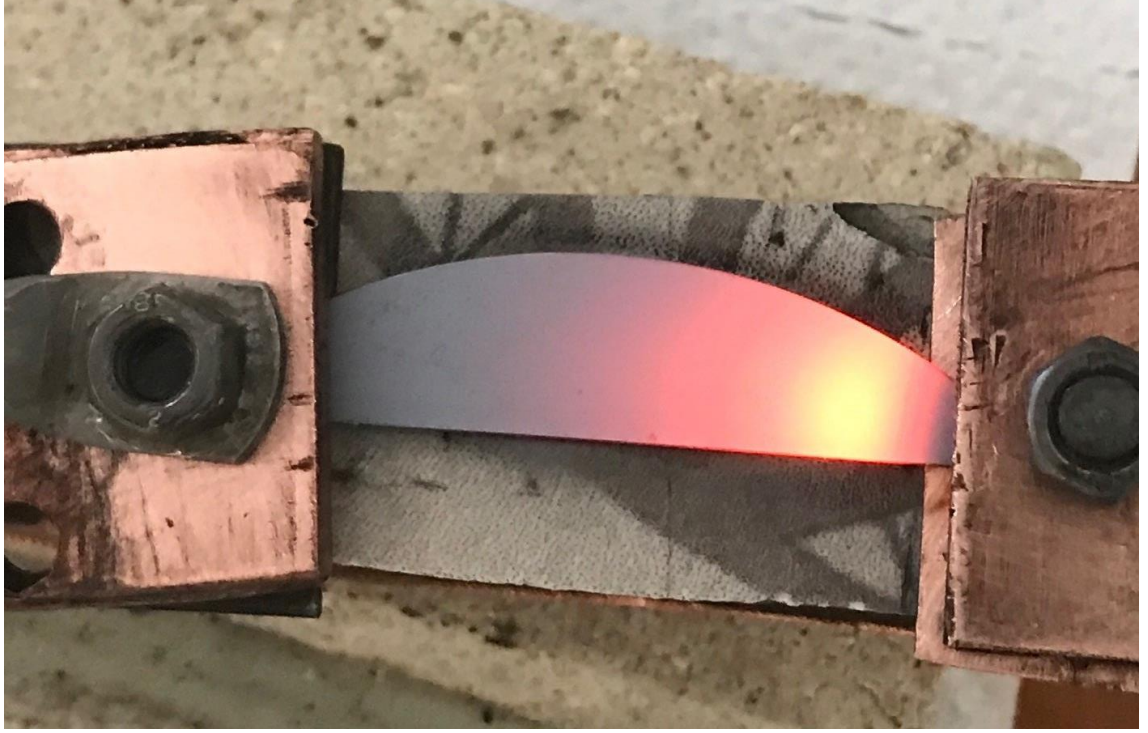
Şekil 3.10.5 Silisyum plakanın joule ısıtılması sırasında oluşan sıcaklık profili
