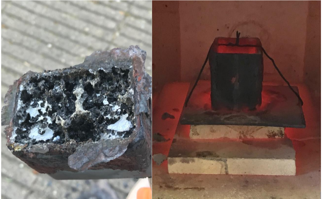
Şekil 3.11.4 NPK gübre ile yapılan denemede yaşanan patlamalar nedeniyle köpük yapı oluşmamıştır.
