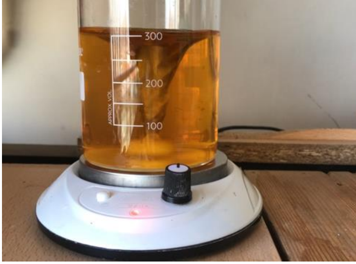
Şekil 3.10.10 FeSO 4 ve FeCl 3 karışımının ısıtıcıli karıştırıcıda hazırlanması
