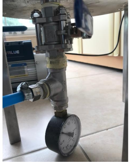
Şekil 3.3.2 Sızdırmazlık contası ve reaktör tabanına manometre bağlantısı
