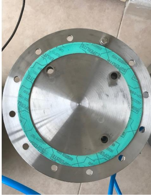
Şekil 3.3.2 Sızdırmazlık contası ve reaktör tabanına manometre bağlantısı
