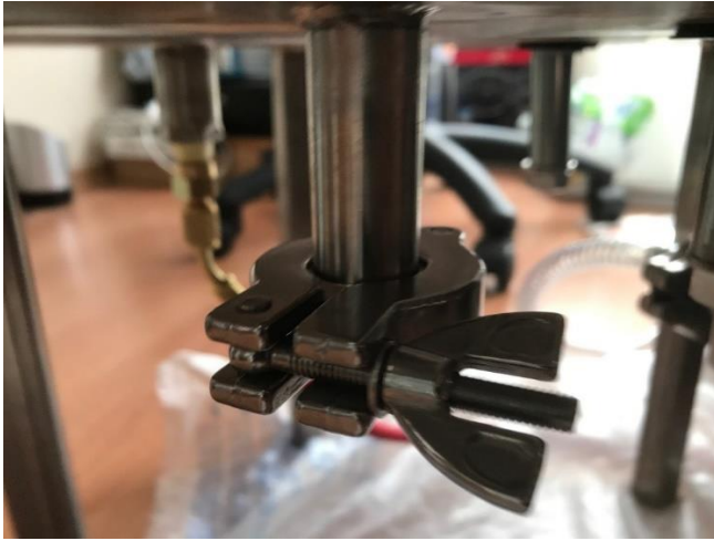
Şekil 3.7.9 KF Flanşların tank tabanına kaynaklanmış halı
