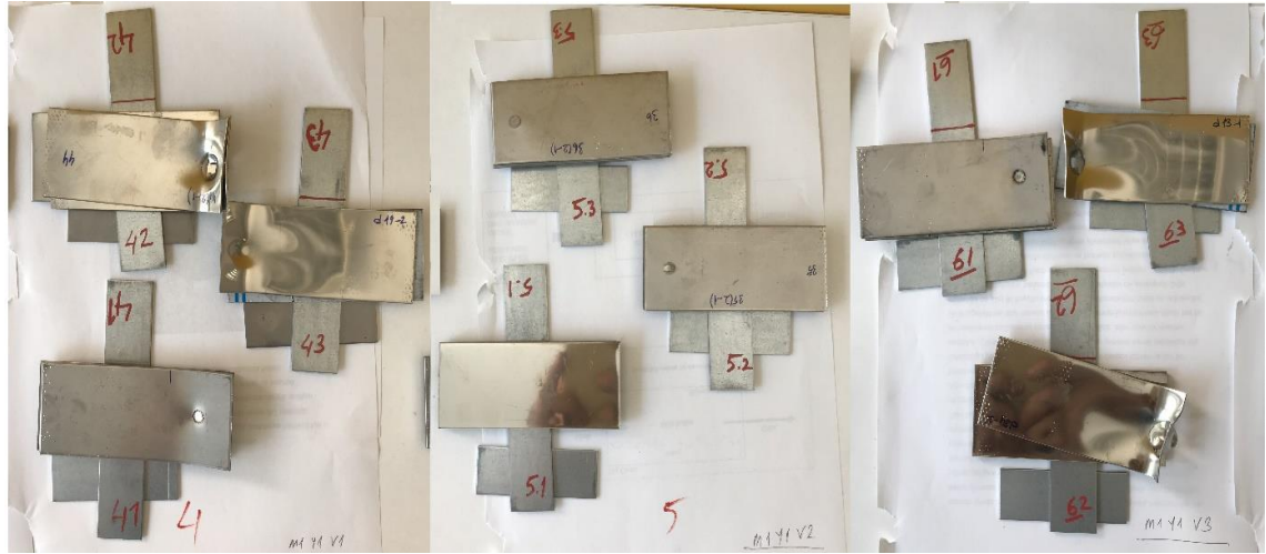
Şekil 4.5. M1 malzemesinin farklı hızlarda plazma işlemi gördükten sonra Y1 ile yapıştırılmasıyla hazırlanan çekme testi numuneleri
