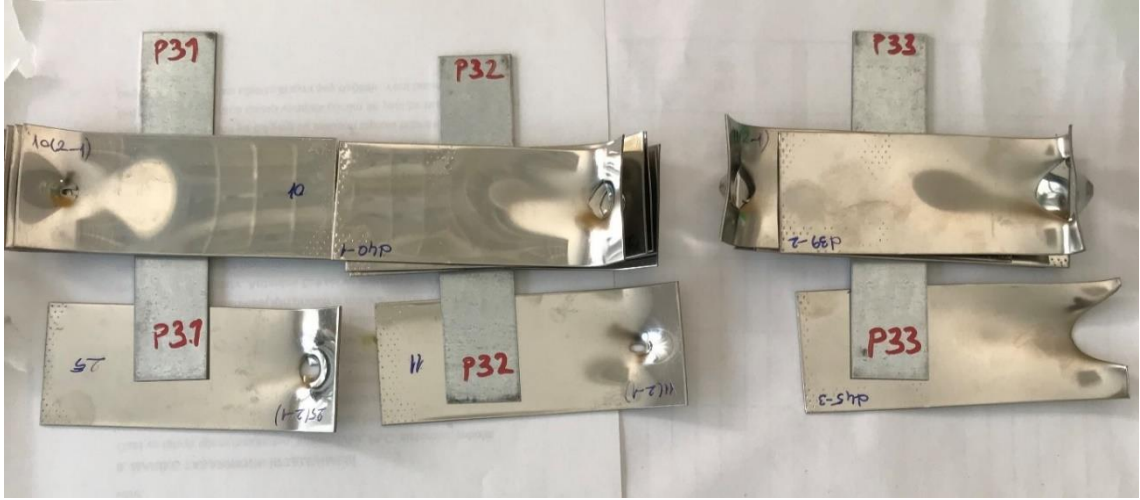
Şekil 4.4. M1 malzemesinin plazma işlemi öncesi Y1 ile yapıştırılmasıyla hazırlanan çekme testi numuneleri
