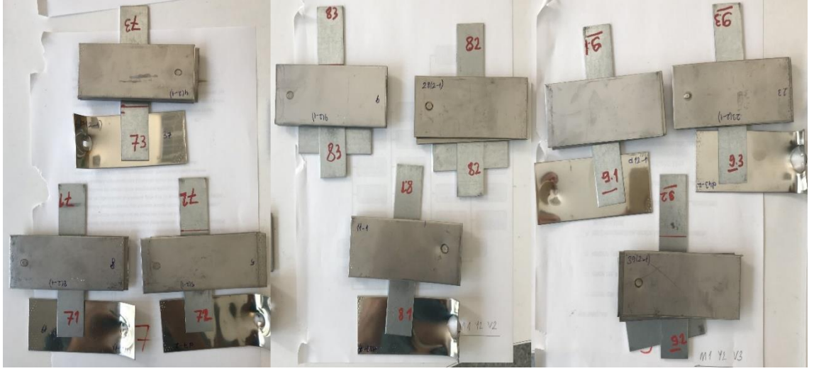
Şekil 4.7. M1 malzemesinin farklı hızlarda plazma işlemi gördükten sonra Y2 ile yapıştırılmasıyla hazırlanan çekme testi numuneleri
