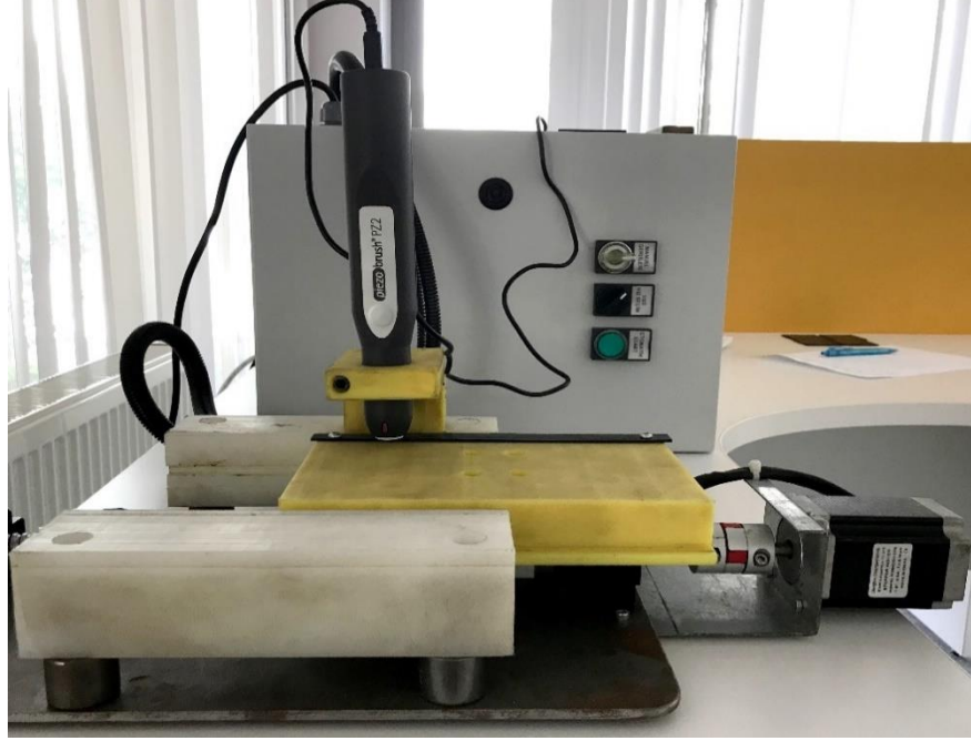
Şekil 3.5. Soğuk ABP işlemi için hazırlanan deney düzeneği
