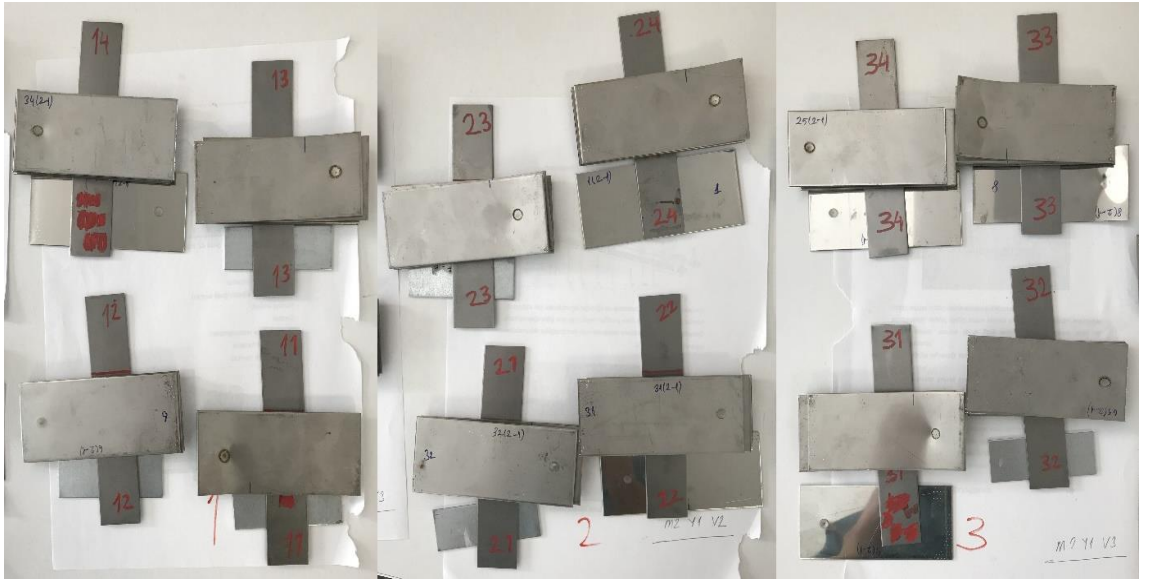
Şekil 4.9. M2 malzemesinin farklı hızlarda plazma işlemi gördükten sonra Y1 ile yapıştırılmasıyla hazırlanan çekme testi numuneleri
