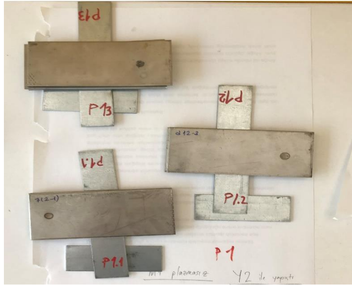
Şekil 4.6. M1 malzemesinin plazma işlemi öncesi Y2 ile yapıştırılmasıyla hazırlanan çekme testi numuneleri
