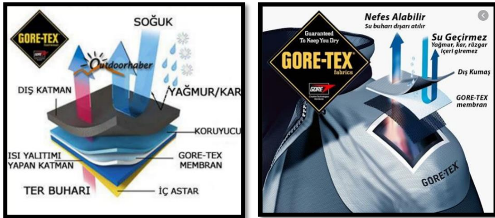
Şekil 2.10. Gore-tex membran ile birleştirilmiş kumaş katları (www.outdoorhaber.com2019)
