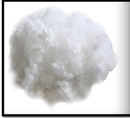
Şekil 3.8. %30-35 boşluklu kesikli hollow elyaf
