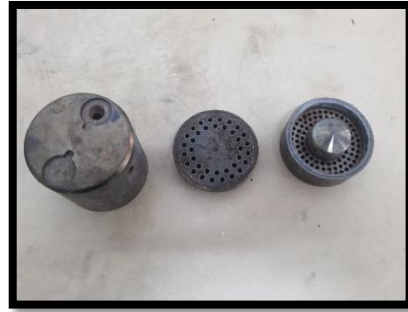
Şekil 3.7. Hollow fiber düzeler a) Alt kafa b) Üst Kafa
