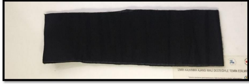
Şekil 3.24. Karbon elyaftan geliştirilen keçe kumaş
