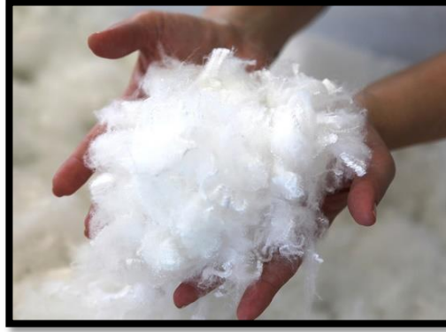
Şekil 3.8. %30-35 boşluklu kesikli hollow elyaf
