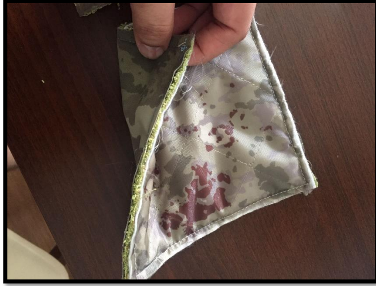
Şekil 3.23. Recycle-pamuklu iplikler ile elde edilen ara katmanlı yapının PTFE membran ve sıkıştırılmış kapitone Recycle-Polyester elyaf ile birleştirilmiş 3 katmanlı yapısı
