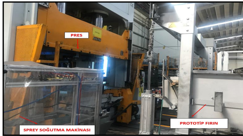
Şekil 4.24. Kalıp, fırın ve sprej makinası hibrit düzeneği
