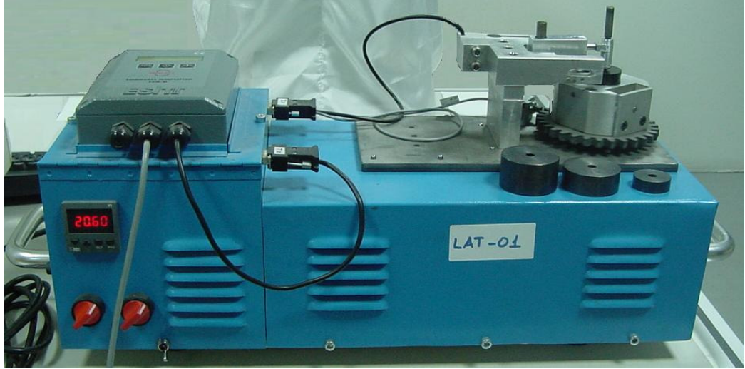
Şekil 2.12. Ball-on-disk aşınma test cihazı fotoğrafı
