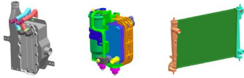
Şekil 3.14. Akıllı Soğutma Sistemi Komponentleri – 3B CAD ( WCOND, WCOND ve LT Radyatörü)
