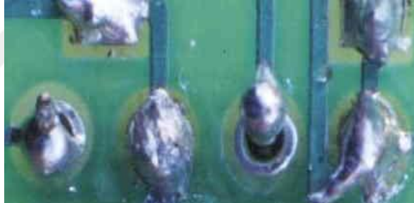
Şekil 79 Hatalı lehim Örnekleri
