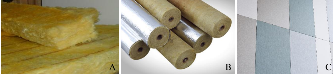
Şekil 2.40. Ses yalıtımında kullanılan malzemeler A) Cam yünü B) Taş yünü C) Akustik panel (C) “Acoustic Panels - Soft Cells Broadline”, t.y.; A) “Cam yünü”, t.y.; B) “Taş yünü”, t.y.)
