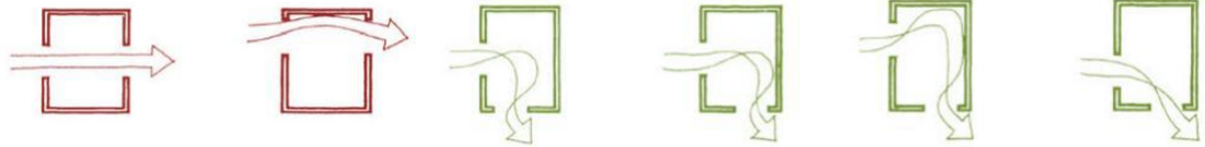
Şekil 2.5. Mekânlardaki açıklıkların konumunun hava hareketine etkisi (Watson ve Labs, 1992)
