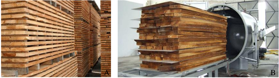
Şekil 2.26. Ahşabın kurutulma şekilleri A) Doğal hava şartlarında kurutma B) Fırın ortamında kurutma (Özdöl, 2010)
