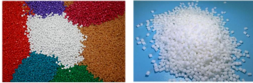
Şekil 2.32. Polimer malzemelerin geri dönüşümünden elde edilen granül maddeler (“Plastik Geri Dönüşüm”, t.y.)
