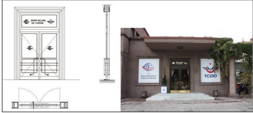
Şekil 4.20. Menteşeli, iki kanatlı, tepe pencereli kapı detay ve fotoğrafı (Özgür Proje (Mimarlık Danışmanlık İnşaat Ltd. Şti.) 2020)
