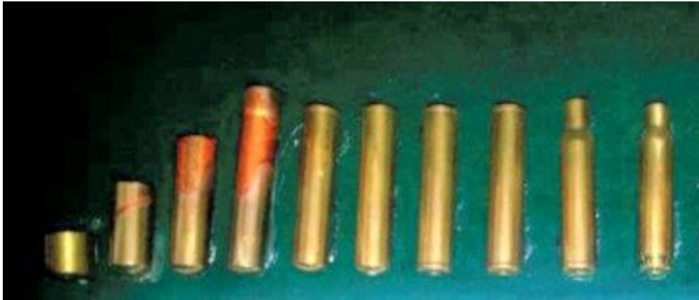
Şekil 2.6. 7,62x51 mm kovanın üretim aşamaları
