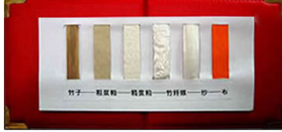
Şekil 1.3. Bambunun, Bambu Kamışından Kumaş Oluşumuna Kadar Değişim Aşamaları ( Bambu - Kalın hamur - İnce hamur - Bambu lifi - Bambu ipliği - Kumaş ) ( http://www.bambrotex.com/second/bamboocenter_patented.htm , 2007 ) .
