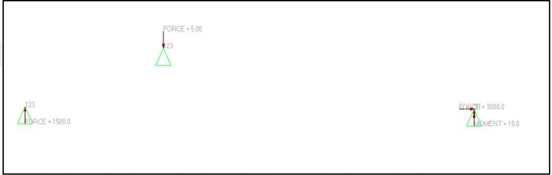
Şekil 3.10., Şekil 3.11., Şekil 3.12. Parçaya sınır şartı, kuvvet ve moment tanımlanması (devam)
