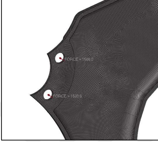
Şekil 3.7. Parçaya 1500 N'luk kuvvet tanımlanması
