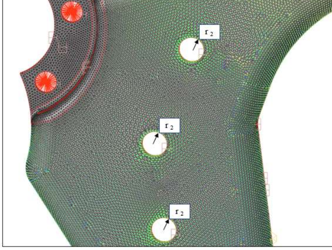
Şekil 4.7. Delik yarıçaplarının genişletilmesi
