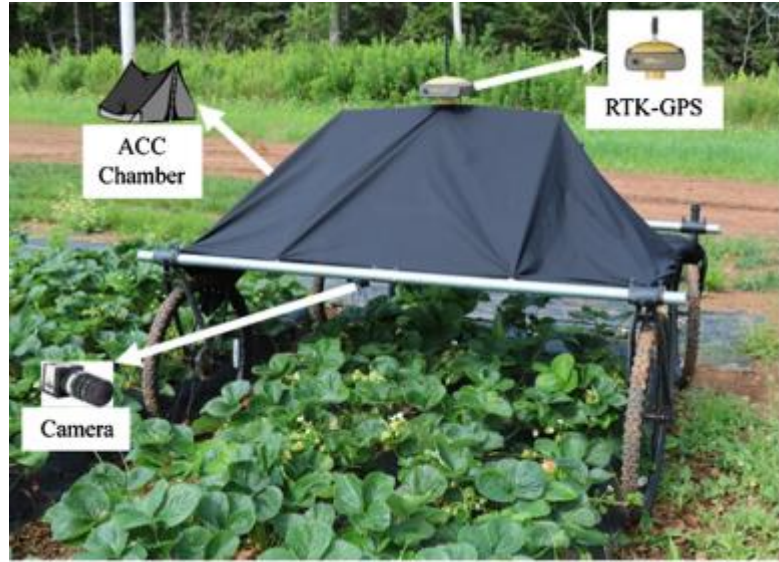
Şekil 2.3. (A) Doğal aydınlatma koşullarında görüntü elde etmek için mobil platform (B) Yapay bulut aydınlatma koşullarında görüntü elde etmek için mobil platform (Sultan Mahmud ve diğerleri, 2019)
