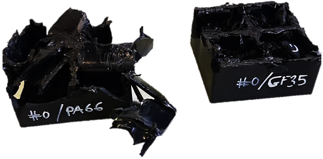
Şekil 4.7. Düşürme testi sonrası numunelerin son görüntüsü
