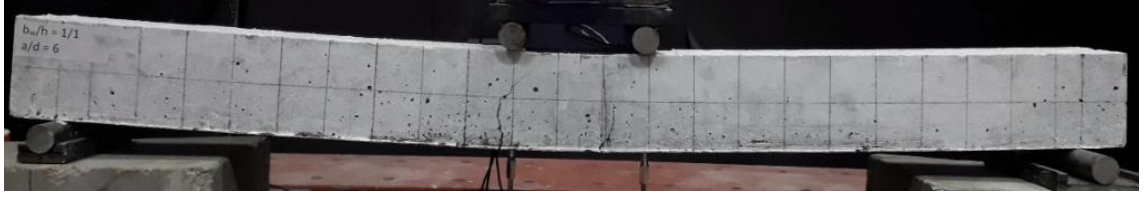
Şekil 4.6 En kesiti 105 mm x 105 mm ( b_w/h=1 ) ve a/d=6 olan numunede donatının akması
