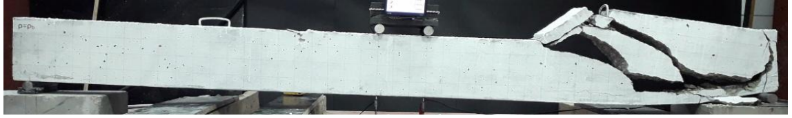
Şekil 4.51. En kesiti 108x200 dengeli donatı oranında donatılı deney sonundaki durumu
