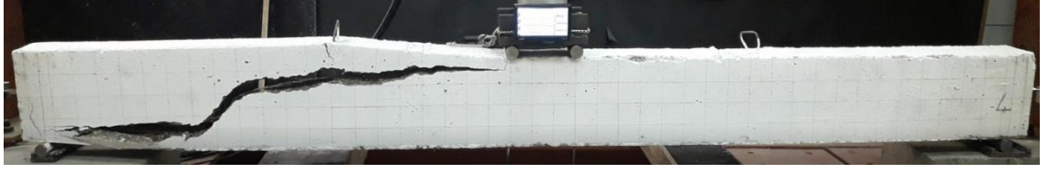
Şekil 4.46. En kesiti 127x200 maksimum donatı oranında donatılı deney numunesinin deney sonundaki durumu
