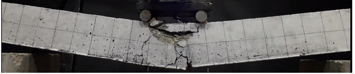
Şekil 4.7. En kesiti 105 mm x 105 mm ( b_w/h=1 ) ve a/d=6 olan numunenin deney sonundaki görüntüsü
