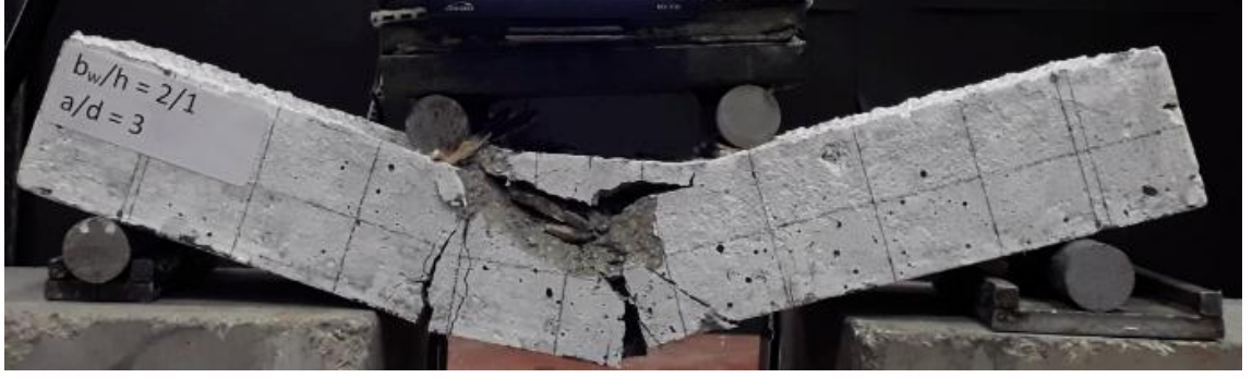
Şekil 4.18. En kesiti 150 mm x 75 mm ( b_w/h=2/1 ) ve a/d=3 olan numunenin deney sonundaki görüntüsü
