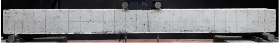
Şekil 4.5. En kesiti 105 mm x 105 mm ( b_w/h=1 ) ve a/d=6 olan numunenin test öncesi görüntüsü
