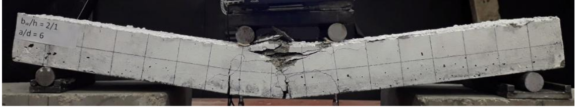
Şekil 4.22. En kesiti 150 mm x 75 mm ( b_w/h=2/1 ) ve a/d=6 olan numunenin deney sonundaki görüntüsü
