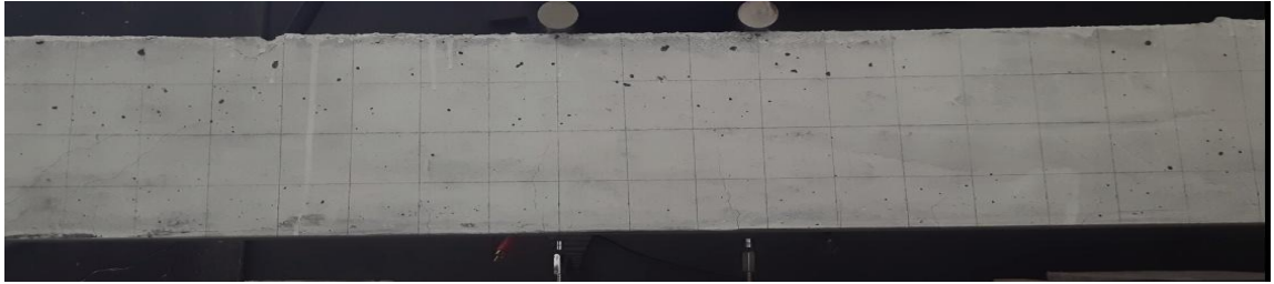
Şekil 4.44. En kesiti 127x200 maksimum donatı oranında donatılı deney numunesinin akma anındaki durumu
