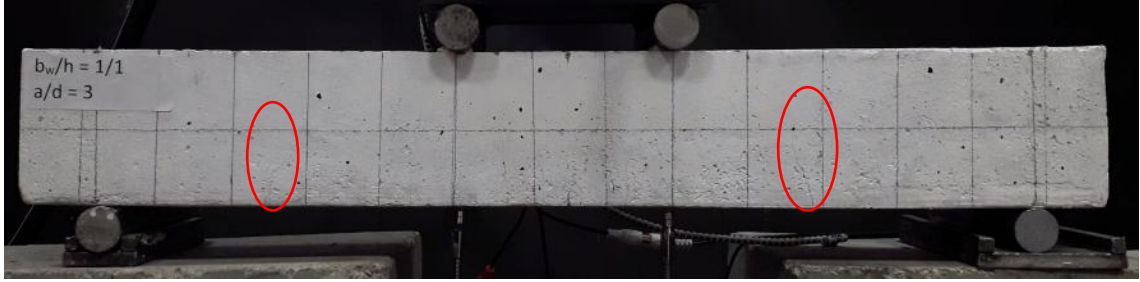
Şekil 4.2 En kesiti 105 mm x 105 mm ( b_w/h=1 ) ve a/d=3 olan numunede oluşan ilk çatlaklar
