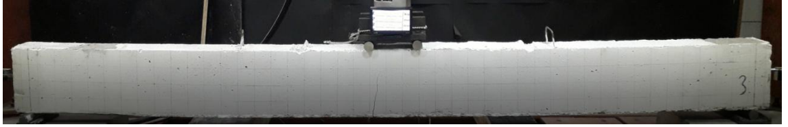
Şekil 4.37. En kesiti 110x200 minimum ile maksimum arası donatı oranından donatılı deney numunesinin akma anındaki davranışı
