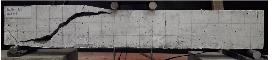
Şekil 4.10. En kesiti 75 mm x 150 mm (bw/h=1/2) ve a/d=3 olan numunenin deney sonundaki görüntüsü
