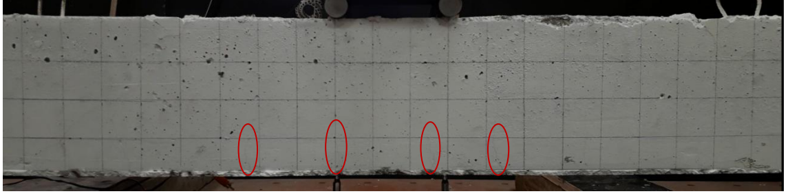
Şekil 4.43. En kesiti 127x200 maksimum donatı oranında donatılı deney numunesinde oluşan ilk çatlaklar
