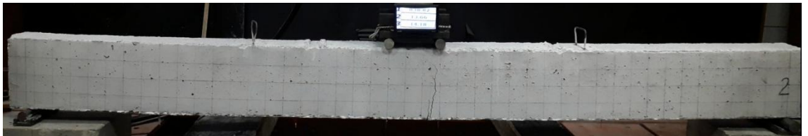
Şekil 4.31. En kesiti 110x200 Minimum donatı oranında donatılı deney numunesin akma durumu
