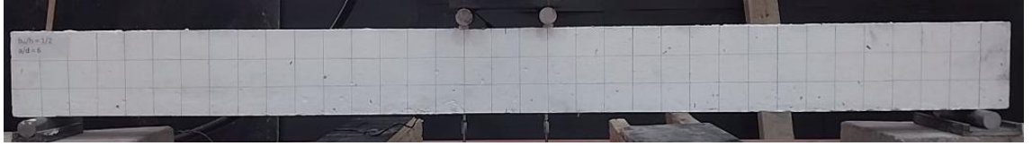
Şekil 4.12. En kesiti 75 mm x 150 mm ( bw/h=1/2 ) ve a/d=6 olan numunenin test öncesi görüntüsü
