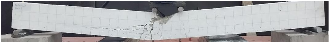
Şekil 4.14. En kesiti 75 mm x 150 mm ( bw/h=1/2 ) ve a/d=6 olan numunenin deney sonundaki görüntüsü
