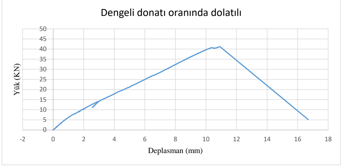
Şekil 4.53. En kesiti 108x200 dengeli donatı oranında donatılı numunesinin sağ LVDT’de elde edilen yük-deplasman eğrisi
