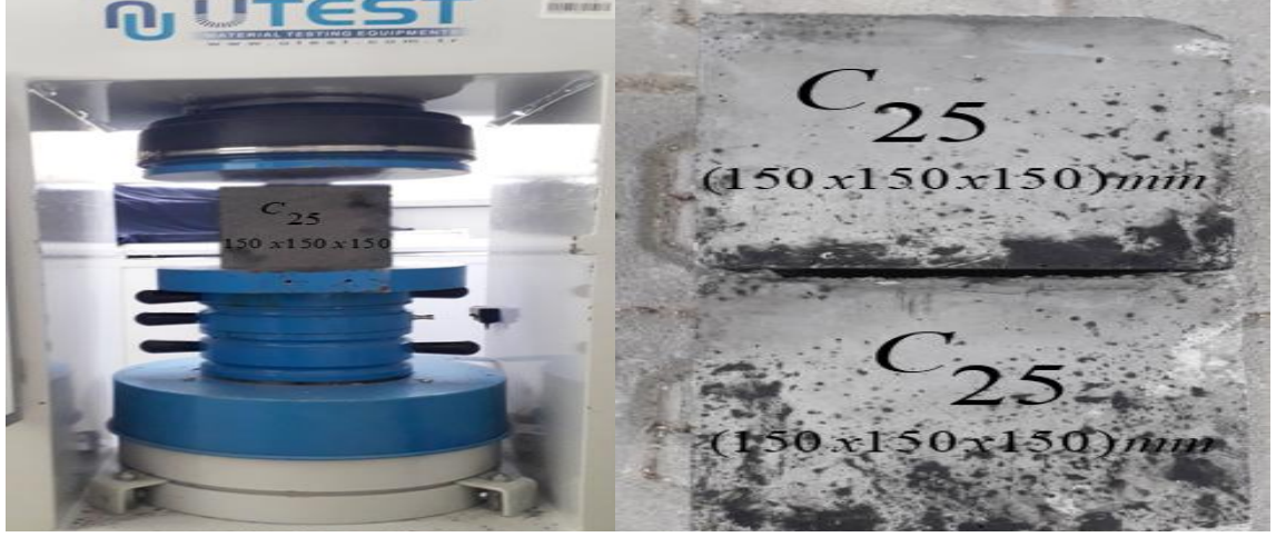
Şekil 3.22. Beton test presi ve test edilmiş küp numuneler
