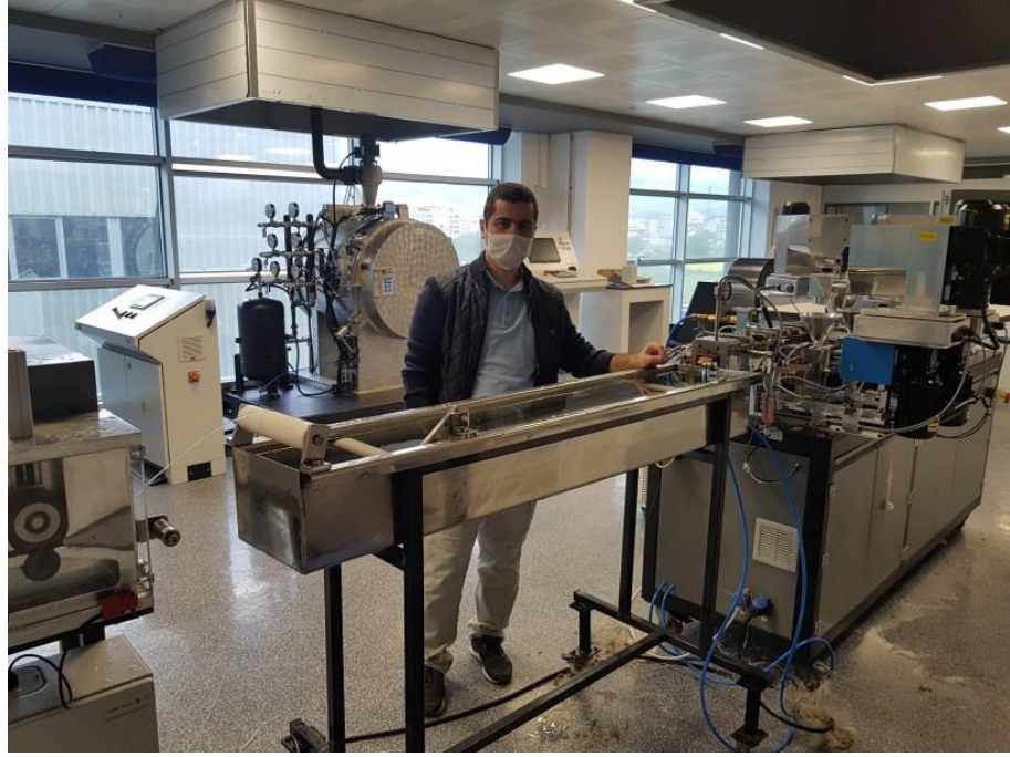
Şekil 3.1. Polmak Plastik 22 mm Lab tipi araştırma ekstrüderi ile kompozit malzeme üretimi
