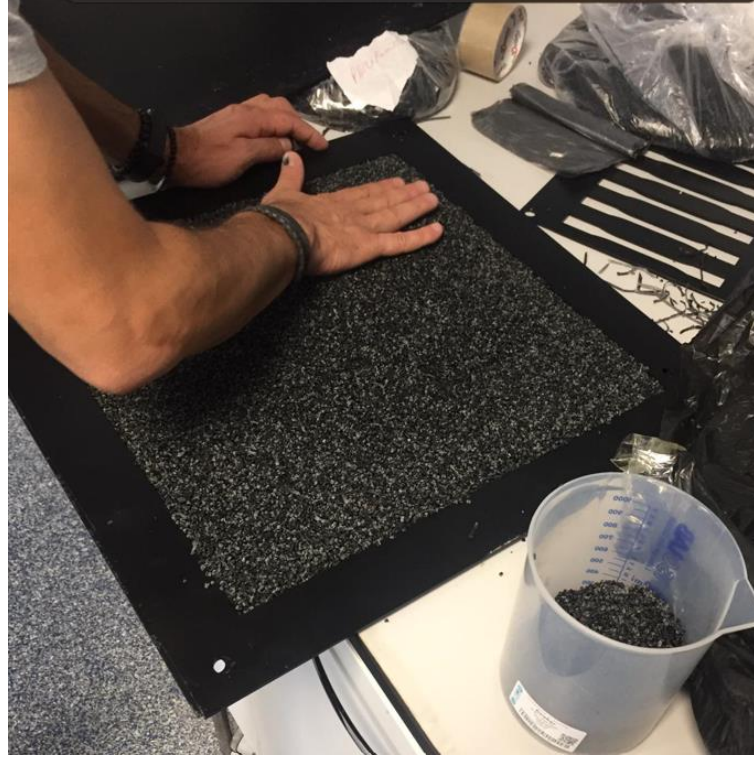
Şekil 3.2. Granür haline getiren kompozitlerin sıcak preslemek için kalıba yerleştirilmesi
