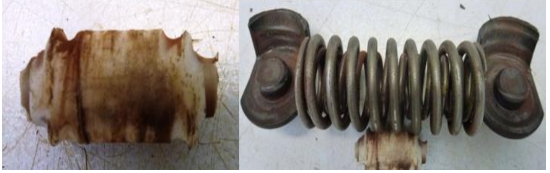
Şekil. 3.28. Hızlandırılmış test ile elde edilmiş termoplastik elastomer yay üzerindeki aşınmalar
