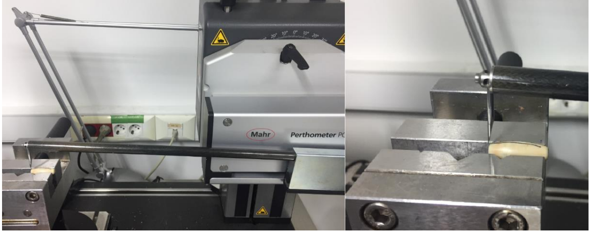
Şekil 3.31. Form tarama ölçüm cihazı ve aşınma ölçümü
