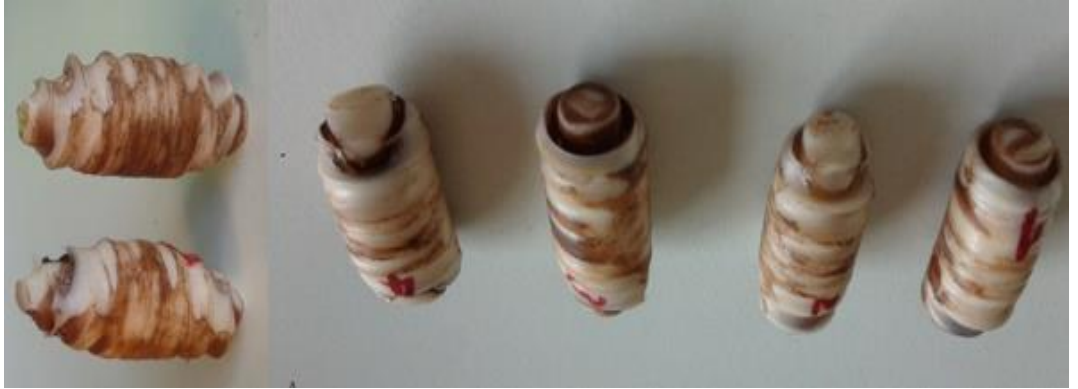
Şekil. 3.27. Araç testinden çıkan aşınmış termoplastik elastomer yaylar
